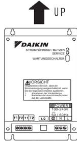
Vergewissern Sie sich, dass Sie das Gerät vertikal einbauen. Bauen Sie das Gerät nicht horizontal ein, da dies zu Fehlfunktionen führen kann.
