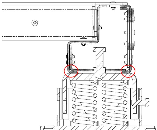
**Fig. 18– Montaje de elementos antivibración (suministrados como opcional)**
