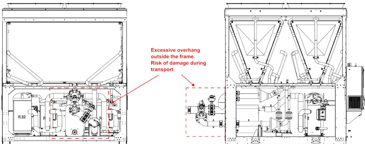
**Fig. 16– Tuberías fuera de la huella de las unidades de refrigeración libre.**
