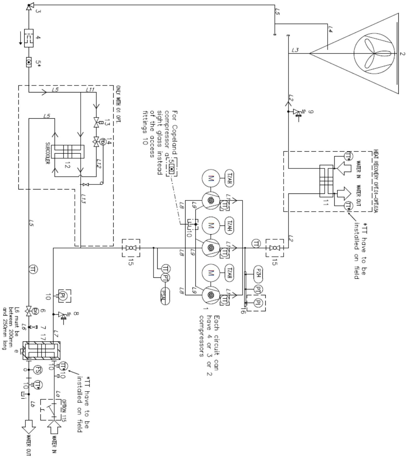
Fig. 2- Diagrama de circuito de refrigerante (P & ID) unidad circuito doble estándar
