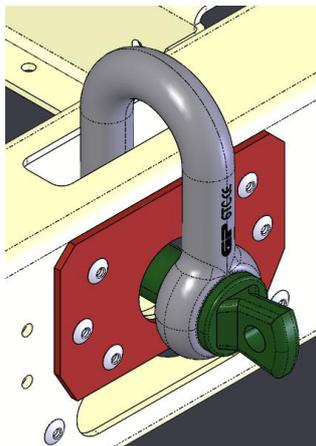
**Fig. 10 - Fijación de los grilletes de elevación**
