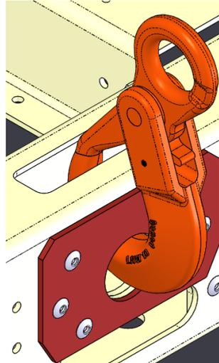
Fig. 9- Fijación del gancho de seguridad
