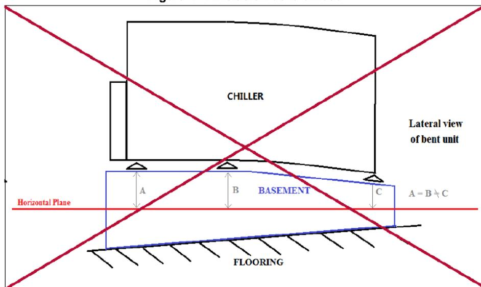
Para instalarla en el suelo es necesario tener una base de cemento resistente, con un espesor mínimo de 250 mm y con un ancho superior al de la unidad.. Esta base debe ser capaz de soportar el peso de la unidad.
