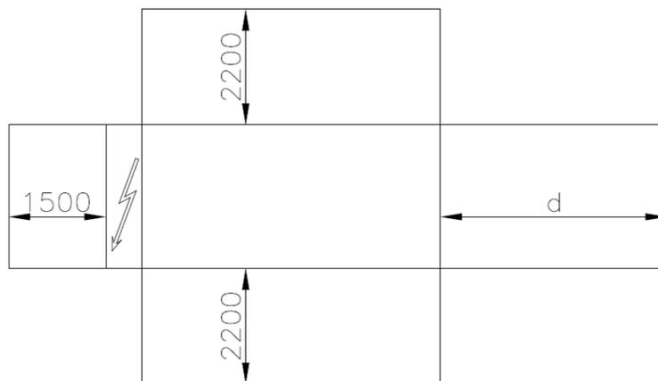
$d = 1500$  mm para unidades de circuito único;  $d = 3000/3500$  mm (en función de las dimensiones del evaporador) para unidades de circuito doble
