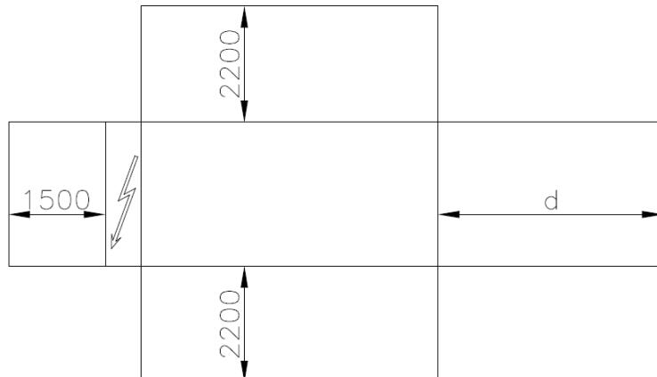
$d = 1500$  мм для одноконтурных агрегатов;  $d = 3000/3500$  мм (в зависимости от размеров испарителя) для двухконтурных агрегатов
