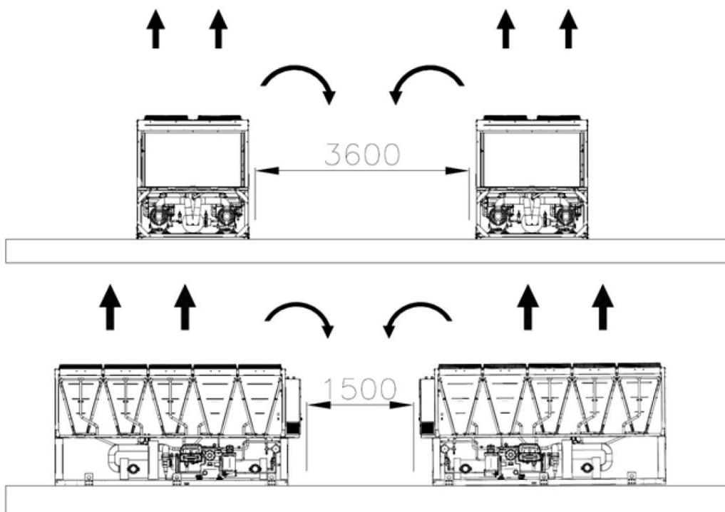
Вышеуказанные расстояния в свету обеспечивают исправную работу чиллера в большей части областей применения. Тем не менее, в некоторых ситуациях, связанных с монтажом нескольких чиллеров, должны соблюдаться следующие рекомендации.
