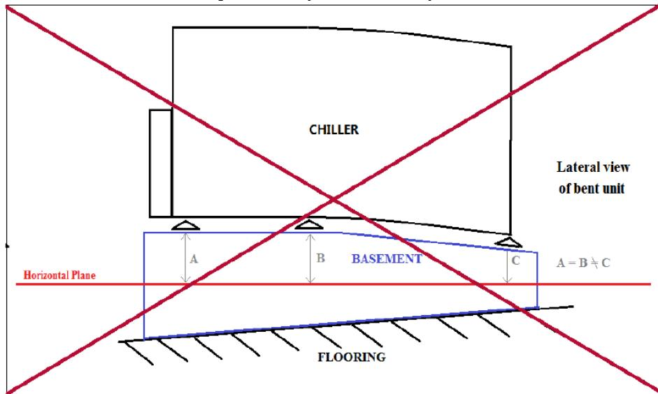
Для монтажа на земле необходимо выполнить прочное бетонное основание толщиной не менее 250 мм и шириной, превышающей ширину агрегата. Основание должно выдерживать вес агрегата.
