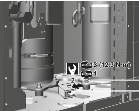
a Крепежная гайка b Транспортировочная распорка
