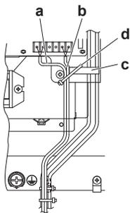
A fixer aux supports en plastique indiqués à l'aide de matériaux de fixation à fournir.
