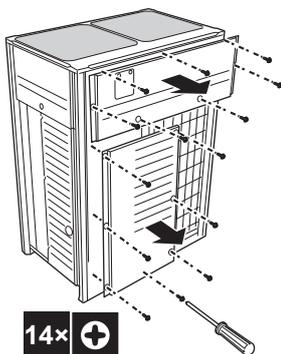
Une fois que les plaques avant sont ouvertes, il est possible d'accéder au coffret électrique. Voir "13.2.2 Pour ouvrir le coffret électrique de l'unité extérieure" [p 16].
