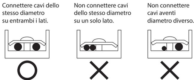
**Nel caso che i conduttori si scaldino troppo a causa di allentamento nella connessione dell'alimentazione, seguire le istruzioni seguenti.**
