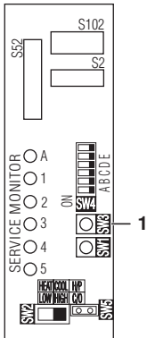
1 Brytare för felkontroll av kabeldragning SW3
