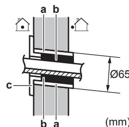
a Tubería empotrada en la pared
