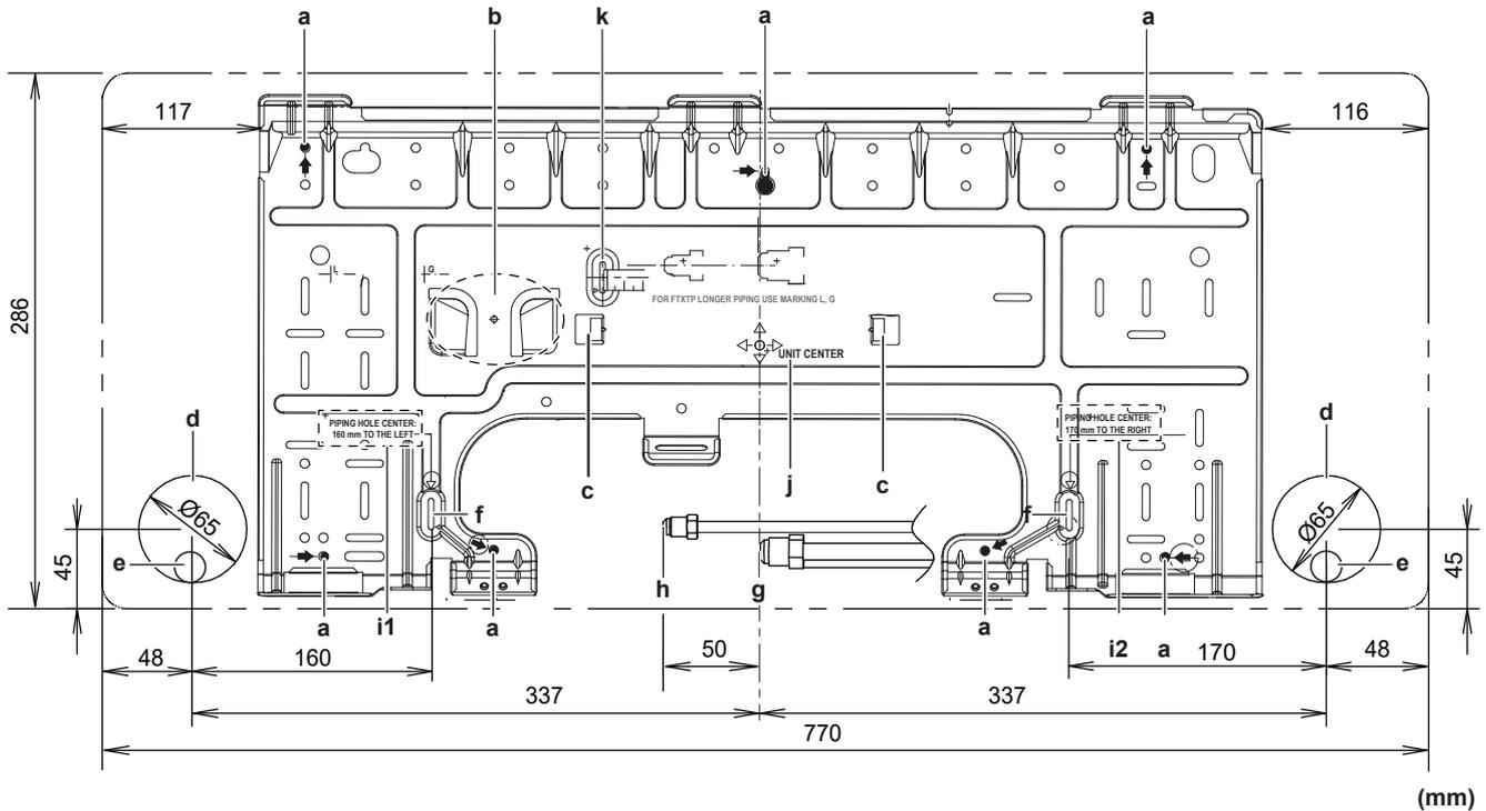
a Puntos de fijación recomendados para la placa de montaje
