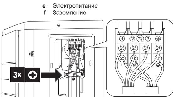
5 Надежно затяните винты клемм. Рекомендуется пользоваться крестовой отверткой.
