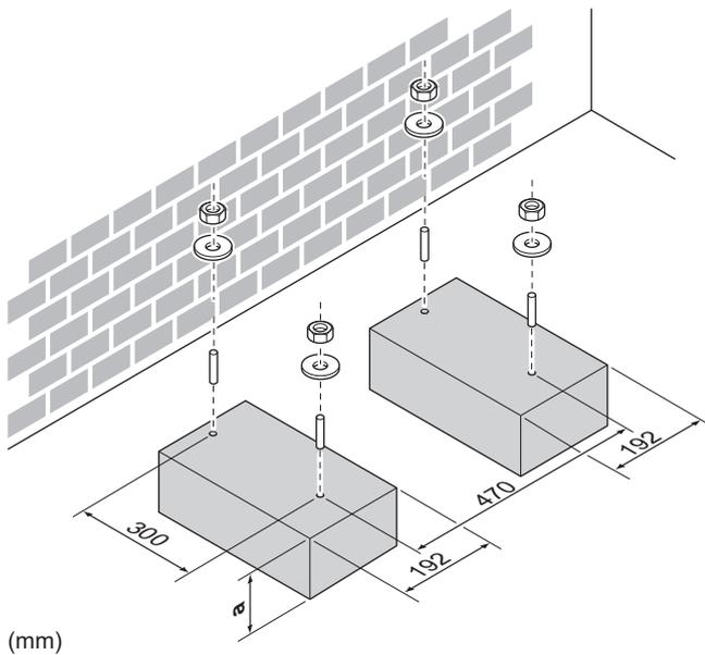
a 100 мм над расчетной поверхностью снежного покрова
