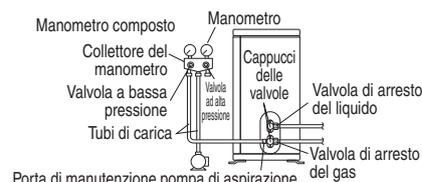
1) Collegare il lato sporgente del tubo flessibile di carico (che proviene dal collettore del manometro) alla porta di manutenzione della valvola di intercettazione del gas.
