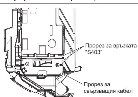
Прорези за свързващите кабели
