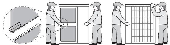
Coloque las manos en la esquina en vez de sujetar la entrada de succión en el lado de la carcasa, de otra forma la carcasa podría deformarse.
