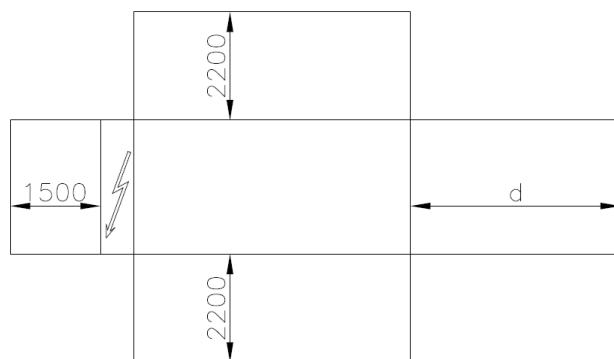
$d = 1.800 \text{ mm}$  για μονάδες μονού κυκλώματος,  $d = 3.000/3.500 \text{ mm}$  (ανάλογα με τις διαστάσεις του εξατμιστή) για μονάδες διπλού κυκλώματος.
