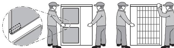
Coloque sus manos en la esquina en vez de sujetar la entrada de aspiración en el lado de la carcasa, de lo contrario, la carcasa podría deformarse.
