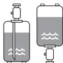
Cargue el líquido refrigerante con el cilindro boca abajo.
