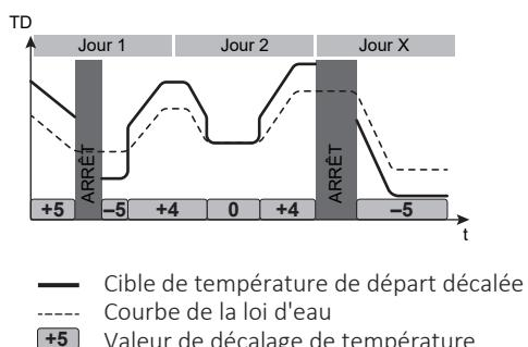
**Remarque :** en cas de programmation de décalage TD, il n'y aura **AUCUN fonctionnement** aux heures où aucun décalage de température n'est programmé.
