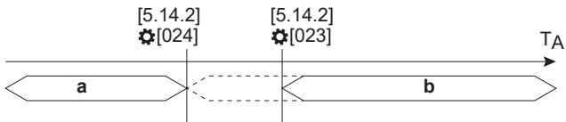
La source de chaleur principale sera décidée en fonction des limites ambiantes dédiées sélectionnées par l'installateur ([5.14.2] **Plage de fonctionnement**: limite supérieure et inférieure). Ce cas est principalement axé sur la capacité (car en dessous de la condition ambiante, la chaudière couvrira la capacité du chauffage).
