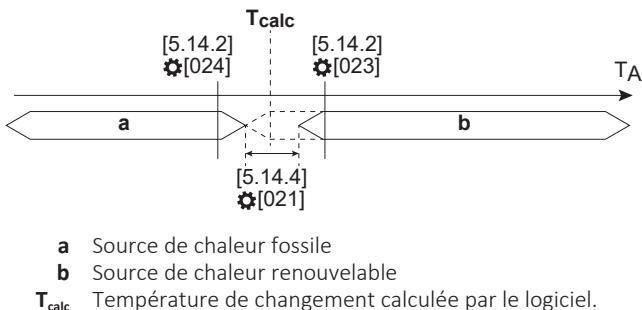
La source de chaleur principale sera décidée en fonction de la condition de changement de relève avec des limites ambiantes dédiées sélectionnées par l'installateur ([5.14.2] **Plage de fonctionnement**: limite supérieure et inférieure).
