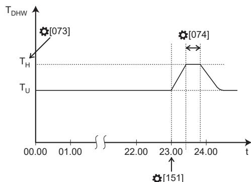
$T_{DHW}$  Température de l'eau chaude sanitaire
