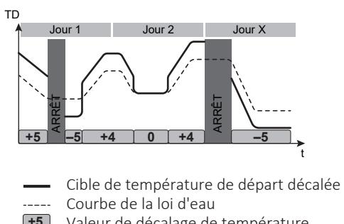
**Remarque :** en cas de programmation de décalage TD, il n'y aura **AUCUN fonctionnement** aux heures où aucun décalage de température n'est programmé.
