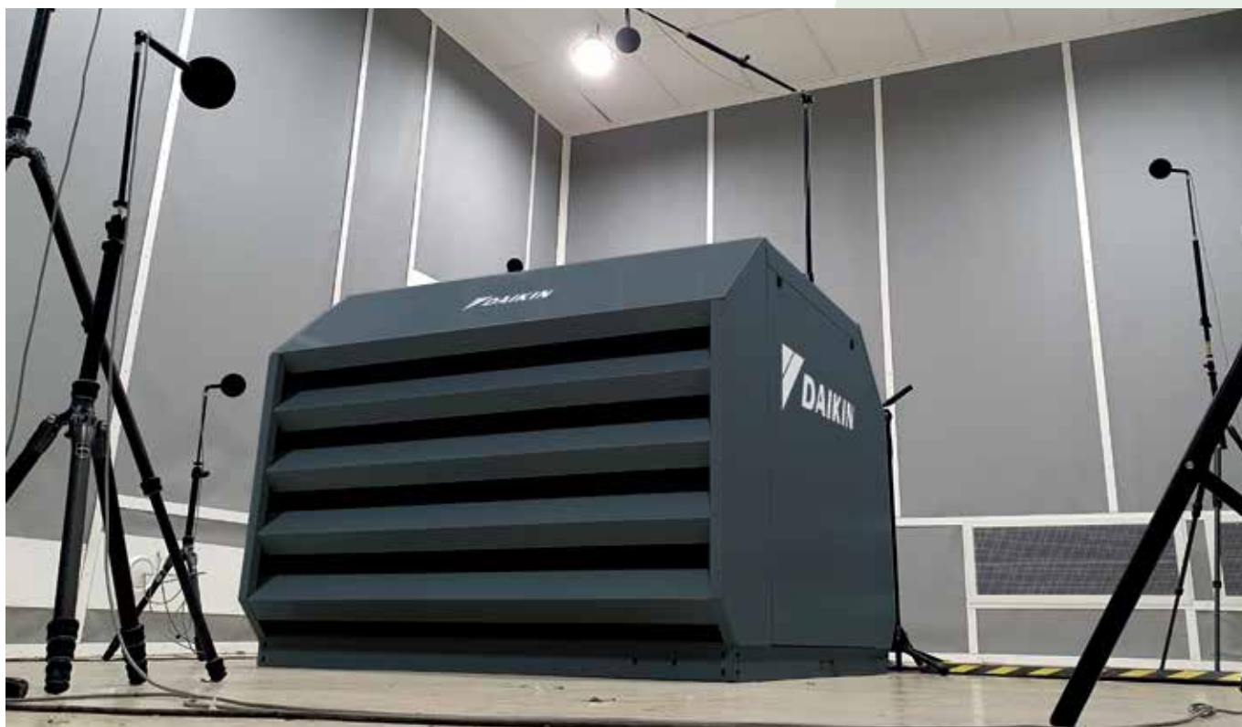
Medição do nível de potência sonora em câmara acústica
