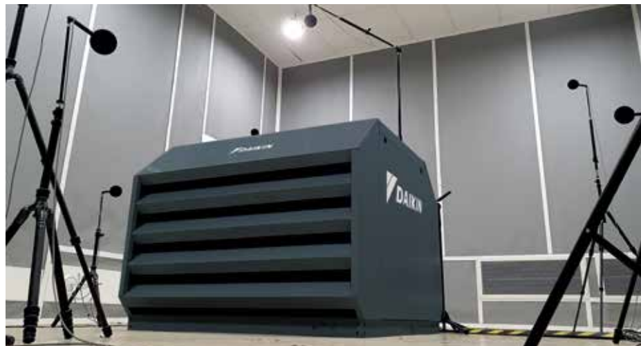
Misura del livello di potenza sonora in camera acustica
