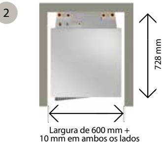
Área útil reduzida: com uma largura de apenas 600 mm e uma profundidade de 728 mm, a unidade interior integrada tem uma área útil semelhante à de outros aparelhos presentes nas habitações.
