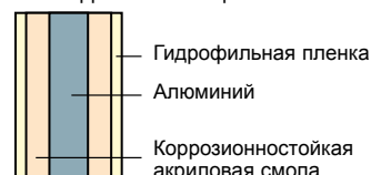
Вид в разрезе теплообменника с антикоррозионной обработкой
