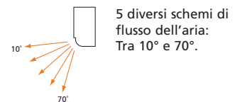
Controllo automatico del flusso dell'aria: L'unità è inizialmente impostata su 10 gradi per il raffreddamento e 70 gradi per il riscaldamento.
