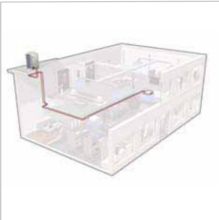
BORU UZUNLUĞU (İÇ ÜNİTE - DIŞ ÜNİTE) Dış ünite ile tüm iç üniteler arası maksimum boru uzunluğu: 200m'ye kadar Dış ünite ile iç ünite arası maksimum montaj yüksekliği farkı: 30 m'ye kadar
