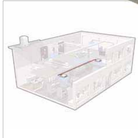
BORU UZUNLUĞU (İÇ ÜNİTE - İÇ ÜNİTE) İç üniteler arası maksimum kot farkı: 4 m'ye kadar
