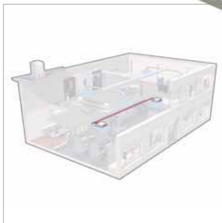
RØRLENGDE INNENDØRS - INNENDØRS Maksimum felles enhetsnivåforskjell innendørs-innendørs opp til 4 m
