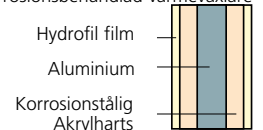
Ett tvärsnitt av en antikorrosionsbehandlad värmeväxlare
