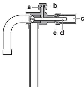
▲ 15-2 Válvula de paragem de parafuso: intersecção
