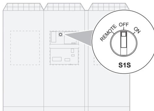
**S1S** Interruptor de funcionamento equipado de fábrica:
