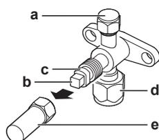
▲ 15-1 Válvula de paragem de parafuso: visão geral das peças
