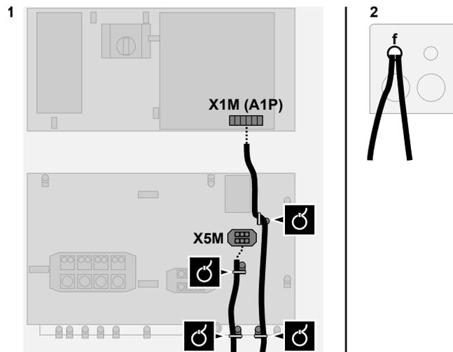
f Entrada da cablagem (pré-orifício) para baixa tensão. Consulte "16.1.3 Diretrizes para abrir orifícios pré-moldados" [▶ 113].
