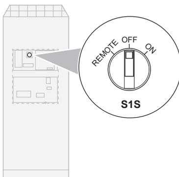
**S1S** Interruptor de funcionamento equipado de fábrica:
