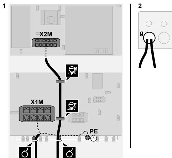
g Entrada da cablagem (pré-orifício) para alta tensão. Consulte "16.1.3 Diretrizes para abrir orifícios pré-moldados" [▶ 113].
