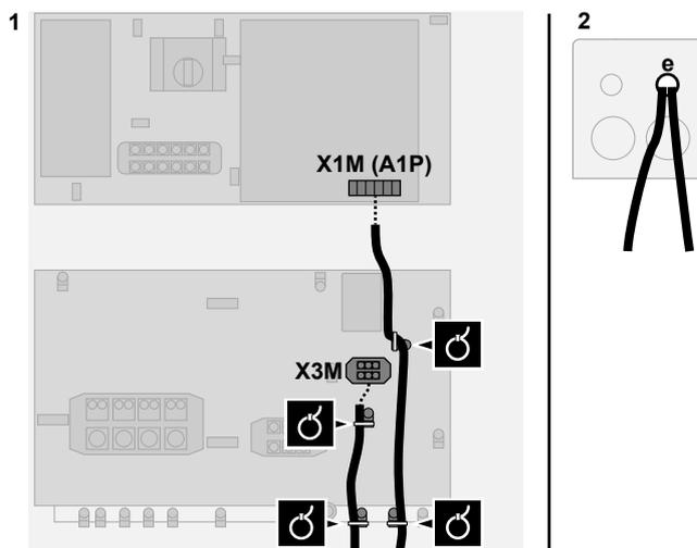
e Entrada da cablagem (pré-orifício) para baixa tensão. Consulte "16.1.3 Diretrizes para abrir orifícios pré-moldados" [▶ 113].
