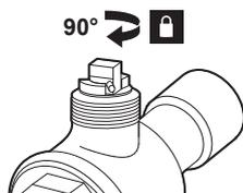
**Ergebnis:** Das Ventil ist vollständig geschlossen:
