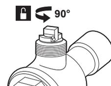
**Ergebnis:** Das Ventil ist vollständig geöffnet:
