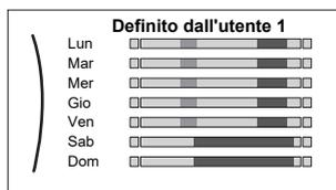
**Prerequisito:** La programmazione della temperatura ambiente è disponibile solo se è attivo il controllo del termostato ambiente. Se il comando di temperatura dell'acqua in uscita è attivo, si può impostare invece la programmazione della zona principale.
