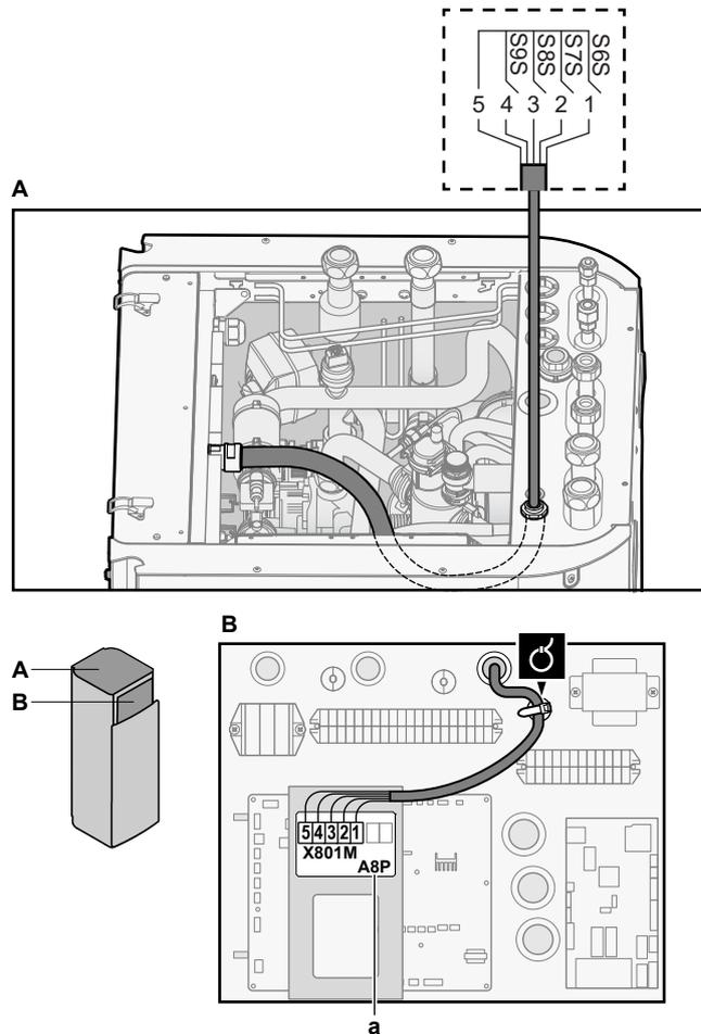
a È richiesta l'installazione della EKR1AHTA (+ piastra di montaggio, vedere "9.4 Installazione della piastra di montaggio" [▶ 143]).
