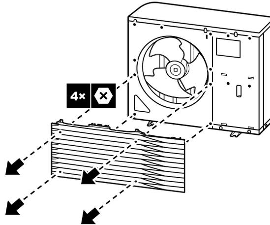
3 Ruotare la parte superiore della griglia di scarico.
