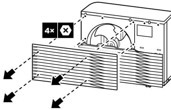
2 Rimuovere la parte inferiore della griglia di scarico.
