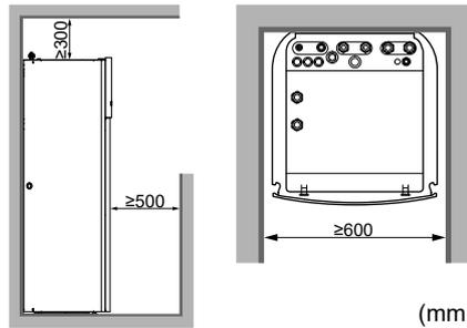
Oltre alle linee guida sulle distanze: Poiché la carica di refrigerante totale nel sistema è di  $\geq 1,84$  kg, l'ambiente in cui si installa l'unità interna deve anche rispettare le condizioni descritte in "7.1.5 Modelli di installazione" [▶ 58].
