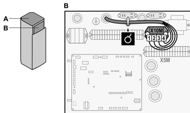
4 Fixez les câbles avec les attache-câbles sur les supports d'attaches. Si nécessaire, regroupez la longueur de câble qui dépasse au moyen d'un attache-câble.
