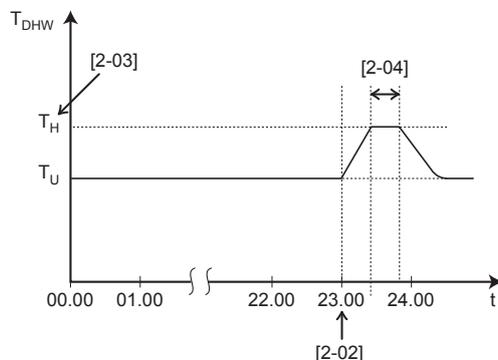
$T_{DHW}$  Température de l'eau chaude sanitaire
