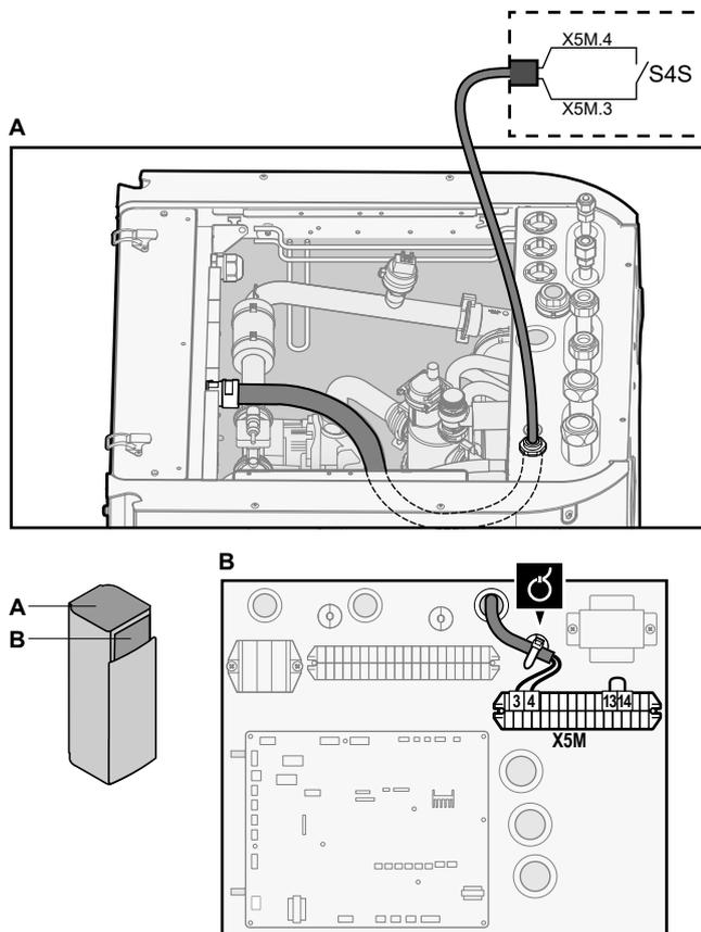
3 Raccordez le câblage haute tension de la manière suivante:
