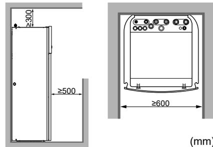
Outre les consignes d'espacement: étant donné que la charge de réfrigérant totale dans le système est  $\geq 1,84$  kg, la pièce où vous installez l'unité intérieure doit également être conforme aux exigences énoncées dans la section "7.1.5 Configurations d'installation" [▶ 73].
