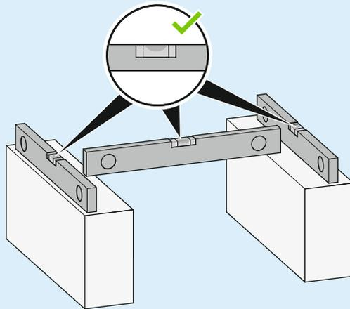
Utilisez 4 jeux de boulons d'ancrage M12, d'écrous et de rondelles. Laissez un espace libre d'au moins 150 mm sous l'unité. Veillez également à ce que l'unité soit positionnée au moins 100 mm au-dessus du niveau maximum de neige envisagé.
