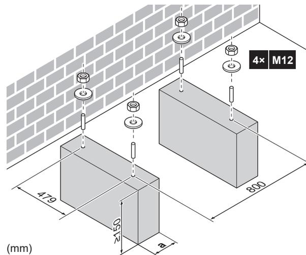
**a** Veillez à ne pas couvrir l'orifice de drainage situé sur la plaque inférieure de l'unité.
