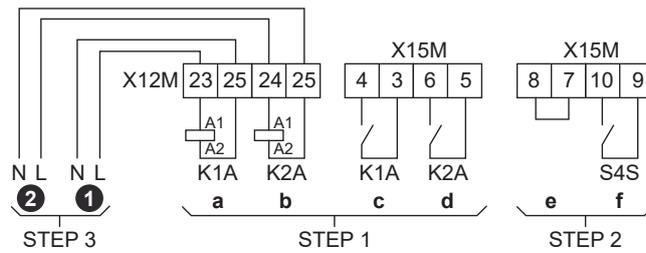
**STEP 1** Монтаж комплекта реле Smart Grid
