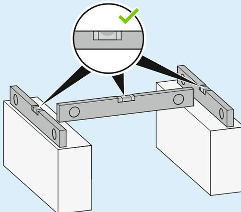
Используйте 4 комплекта анкерных болтов M12, гаек и шайб. Предусмотрите под агрегатом свободное пространство как минимум 150 мм. Кроме того, убедитесь, что агрегат устанавливается как минимум на 100 мм выше максимального ожидаемого уровня снежного покрова.
