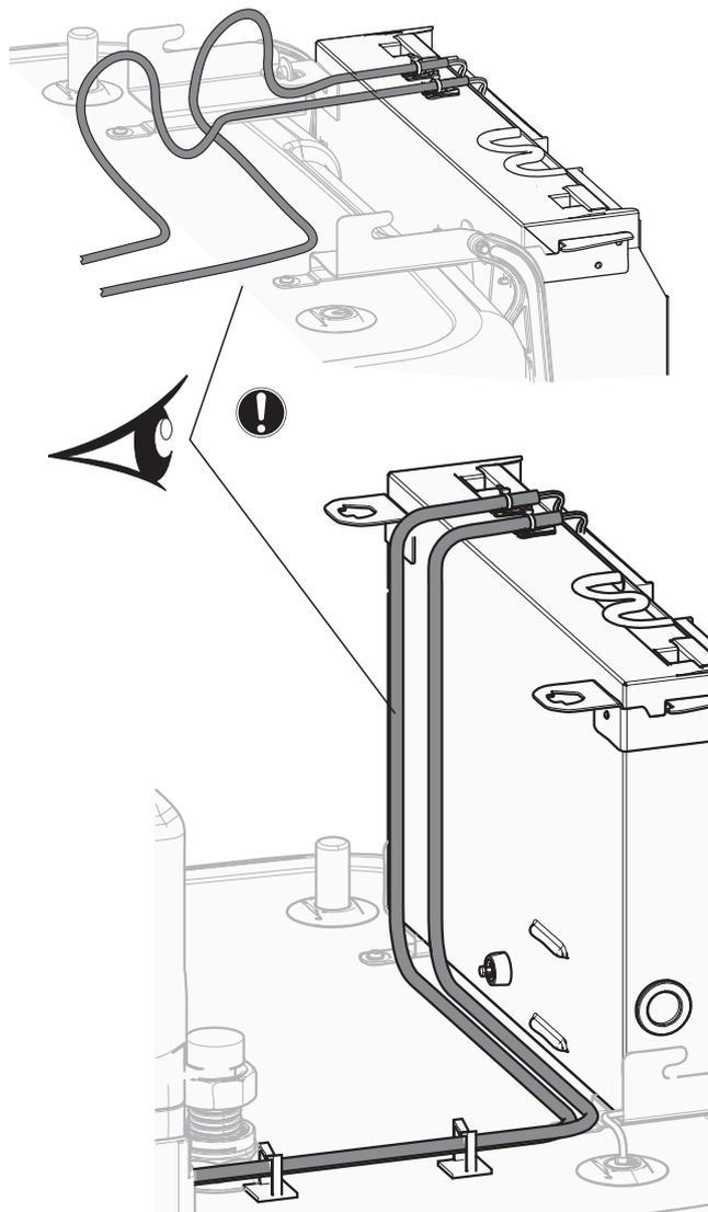
Все кабели, подключаемые к распределительной коробке ECH<sub>2</sub>O, должны быть закреплены фиксаторами для разгрузки натяжения.
