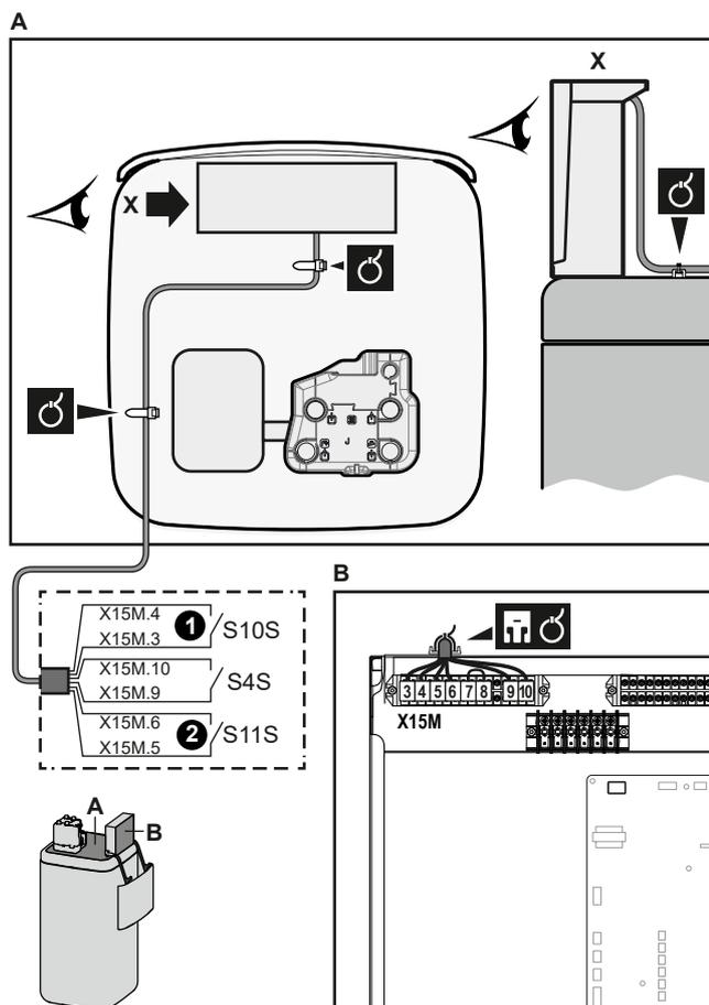
3 Зафиксируйте кабели с помощью стяжек на креплениях кабельных стяжек.
