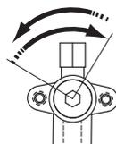
Отвинчивается против часовой стрелки
