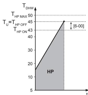
**HP** Тепловой насос. Когда нагрев тепловым насосом занимает слишком много времени, возможен дополнительный нагрев резервным нагревателем
