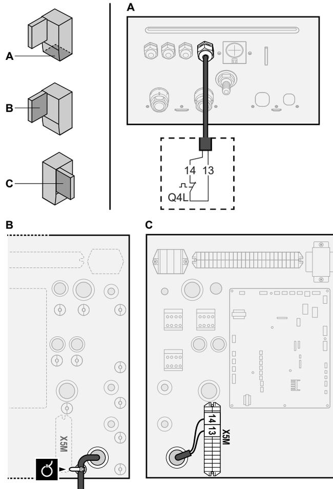
4 Зафиксируйте кабель с помощью стяжек на креплениях кабельных стяжек.
