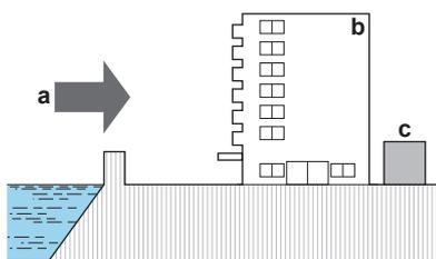
Если наружный агрегат подвергается прямому воздействию морских ветров, установите ветрозащитный щит.
