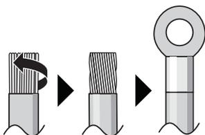
**Для установки проводов используйте следующий способ:**
