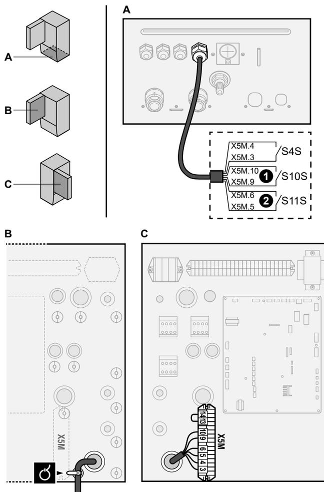
2 Зафиксируйте кабели с помощью стяжек на креплениях кабельных стяжек.
