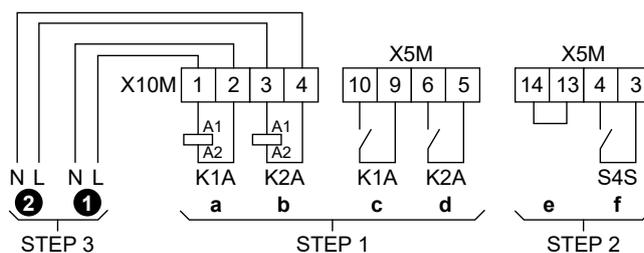
**STEP 1** Монтаж комплекта реле Smart Grid
