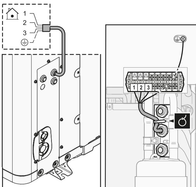
9.2.3 Перемещение термистора воздуха на наружный агрегат
