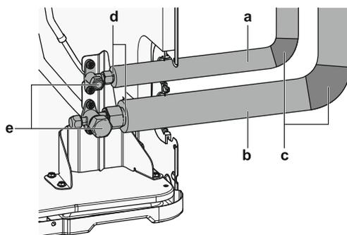
**5** Если наружный агрегат установлен выше внутреннего агрегата, покройте запорные вентили (e, см. выше) уплотнительным материалом, чтобы предотвратить попадание водяного конденсата с этих вентилей во внутренний агрегат.
