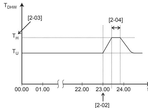
$T_{DHW}$  Температура горячей воды бытового потребления
