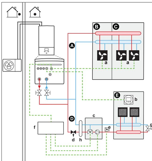
3 Система с гидравлическим сепаратором для обеих зон:
