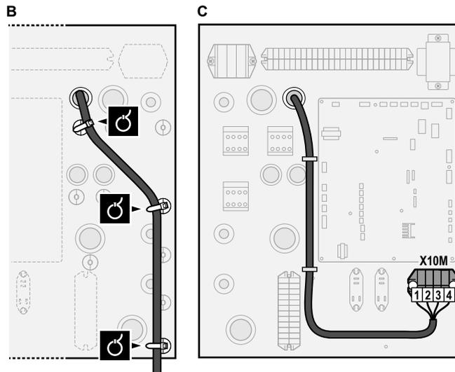
4 Зафиксируйте кабели с помощью стяжек на креплениях кабельных стяжек. При необходимости закрепите слишком длинный кабель кабельной стяжкой.
