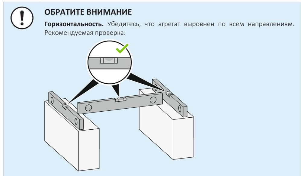
Используйте 4 комплекта анкерных болтов М12, гаек и шайб. Предусмотрите под агрегатом свободное пространство как минимум 150 мм. Кроме того, убедитесь, что агрегат устанавливается как минимум на 100 мм выше максимального ожидаемого уровня снежного покрова.
