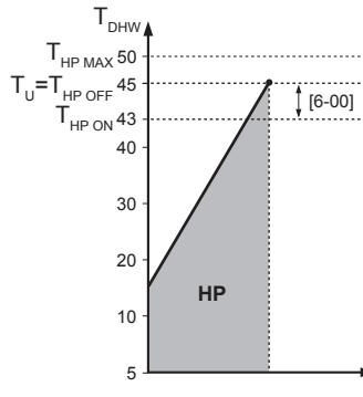
**HP** Bomba de calor. Si el tiempo de calentamiento por bomba de calor es excesivo puede activarse la resistencia de reserva para proporcionar un calentamiento adicional
