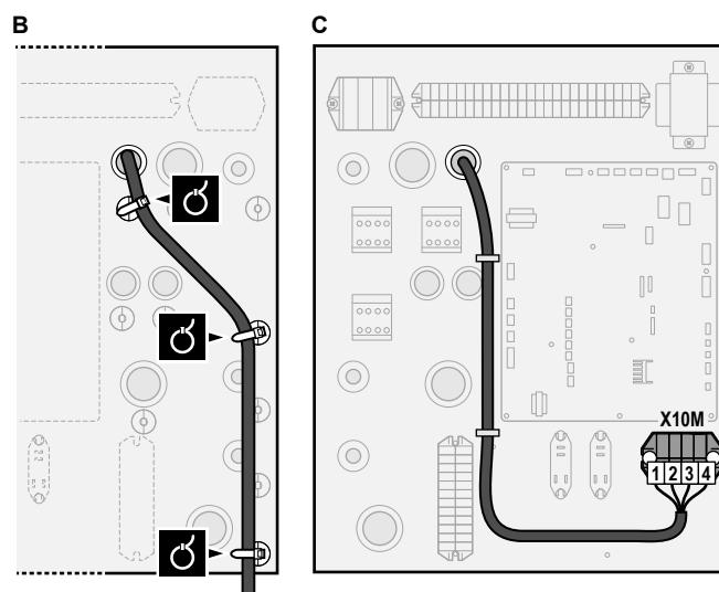
**4** Fije los cables con abrazaderas a los sujetacables. Si es necesario, recoja la longitud sobrante de cable con una abrazadera.
