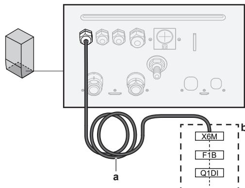
a Cable montado de fábrica conectado al contactor de resistencia de reserva dentro de la caja de interruptores (K5M)
