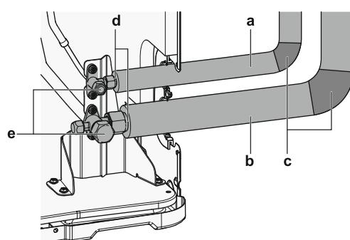
**5** Si la unidad exterior está instalada encima de la unidad interior, cubra las válvulas de cierre (e, véase arriba) con material sellante para evitar que el agua condensada en las válvulas de cierre penetre en la unidad interior.
