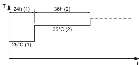
**T** Temperatura del agua de impulsión deseada (15~55°C)
