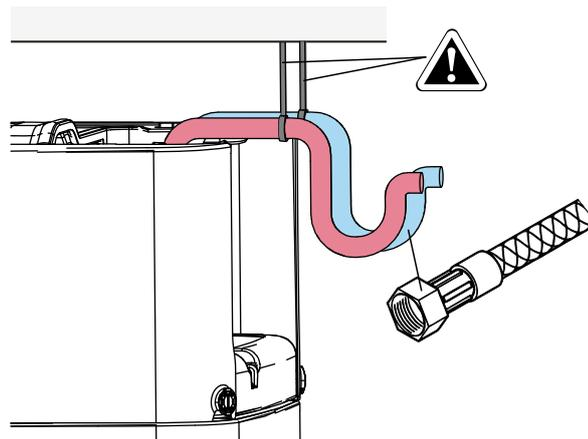
**7** Installieren Sie die thermische Isolierung des Hydraulikblocks.
