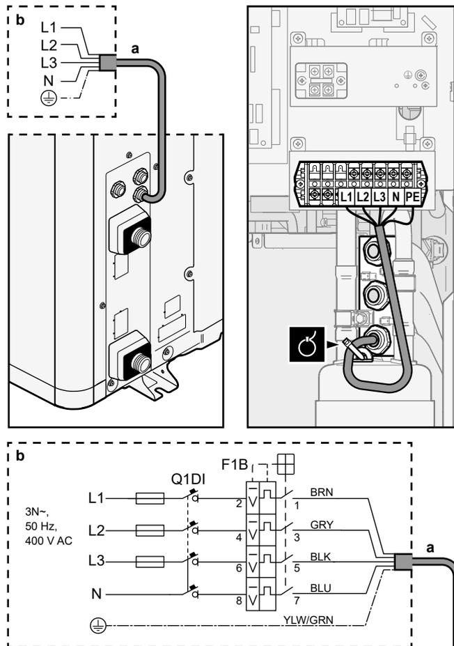
**a** Stromversorgungskabel (bauseitige Bereitstellung)
