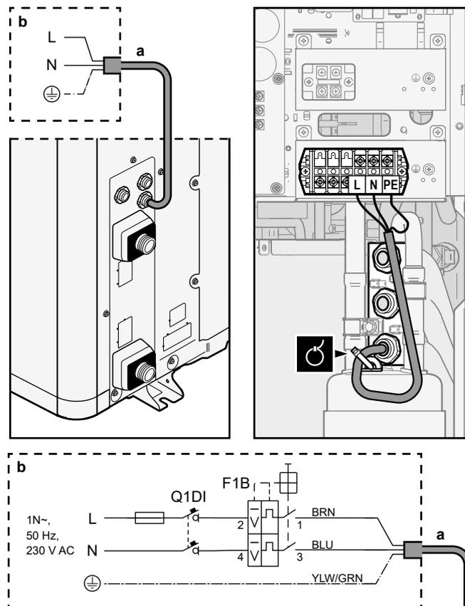
**a** Stromversorgungskabel (bauseitige Bereitstellung)
