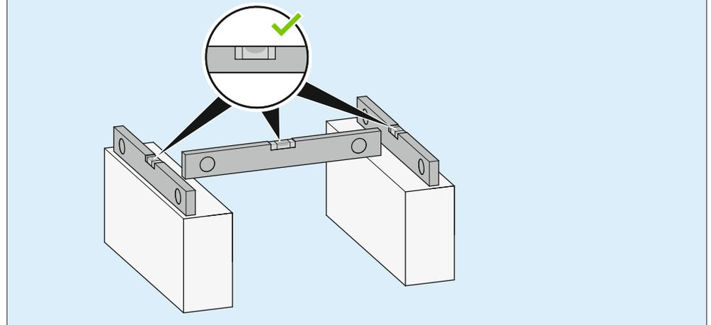
Verwenden Sie 4 Sätze mit M12-Ankerbolzen, Muttern und Unterlegscheiben. Lassen Sie mindestens 150 mm Freiraum unter dem Gerät. Stellen Sie zusätzlich sicher, dass das Gerät mindestens 100 mm über der maximal zu erwartenden Schneehöhe positioniert ist.
