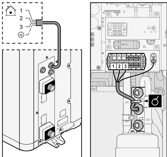
**3 (optional) Ablaufschlauchheizelement-Kabel:**
