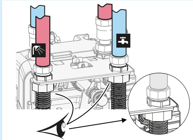
**6** Stützen Sie die Wasserleitungen ab.
