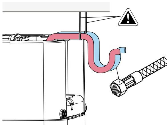
**6** Installieren Sie die thermische Isolierung des Hydraulikblocks.
