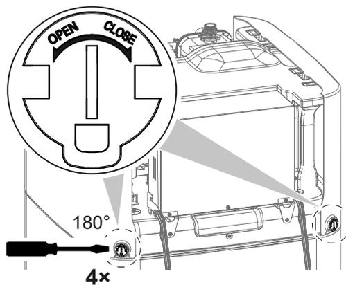
2 Heben Sie die Seitenteile an.
