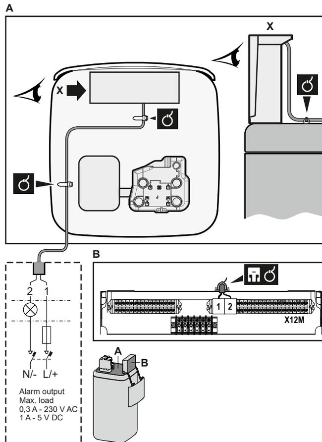
3 Befestigen Sie das Kabel mit Kabelbindern an den Kabelbinderhalterungen. Allgemeine Informationen finden Sie unter "9.3.1 Die elektrischen Leitungen an die Inneneinheiten anschließen" [▶ 139].
