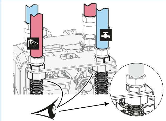
**5** Stützen Sie die Wasserleitungen ab.
