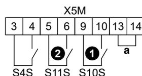
a Fil de liaison (installé en usine). Si vous raccordez également un thermostat de sécurité (Q4L), remplacez le fil de liaison par les fils du thermostat de sécurité.
