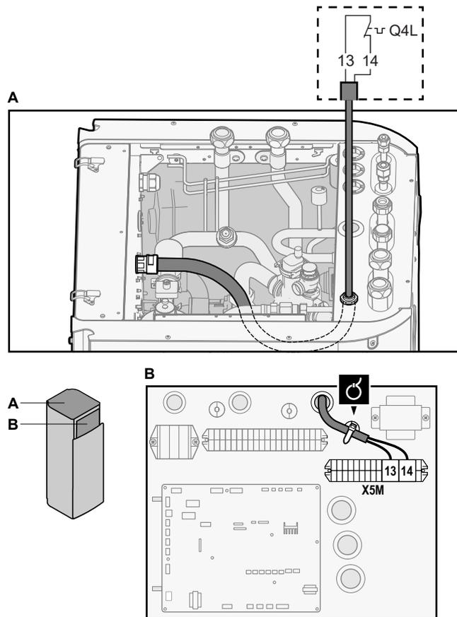
5 Fixez le câble avec les attache-câbles sur les supports d'attaches.
