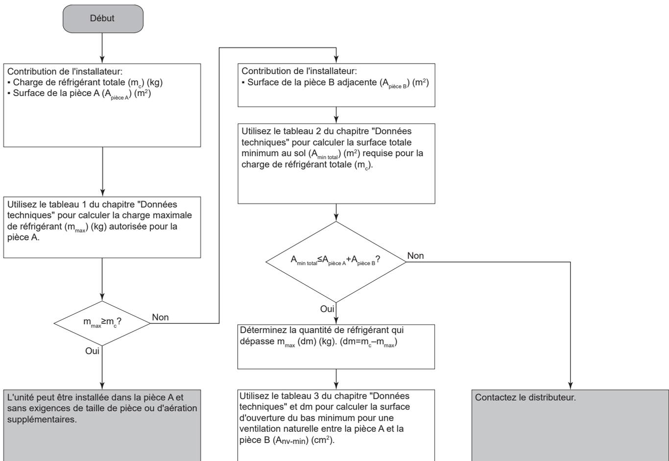
L'unité peut être installée dans la **pièce A** si vous fournissez 2 ouvertures (une au bas, une sur le haut) entre la pièce A et B pour assurer une ventilation naturelle. Les ouvertures doivent être conformes aux conditions suivantes:
