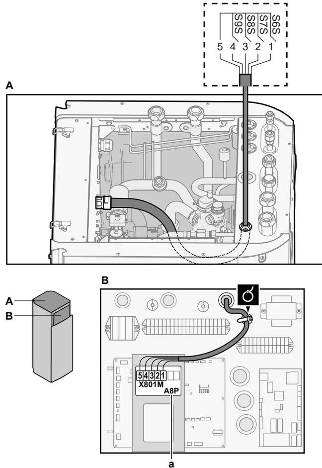
a L'installation de la EKR1AHTA (+ plaque de montage, reportez-vous à "9.4 Installation de la plaque de montage" [▶ 127]) est nécessaire.
