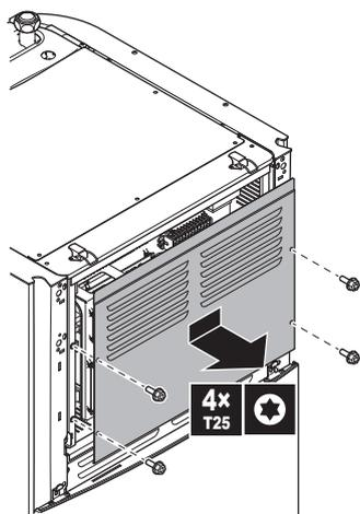
**4** Si nécessaire, retirez la plaque frontale. Cela s'avère par exemple nécessaire dans les cas suivants:
