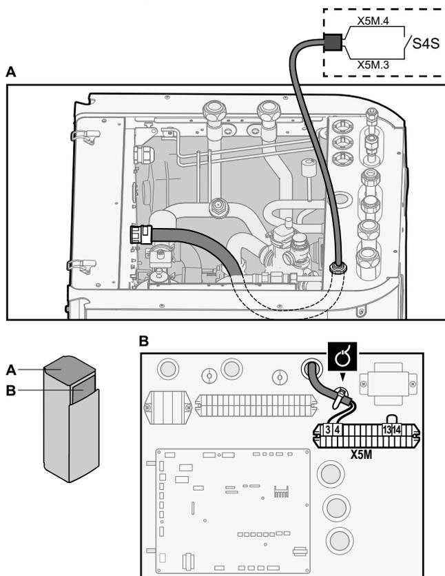
3 Raccordez le câblage haute tension de la manière suivante:
