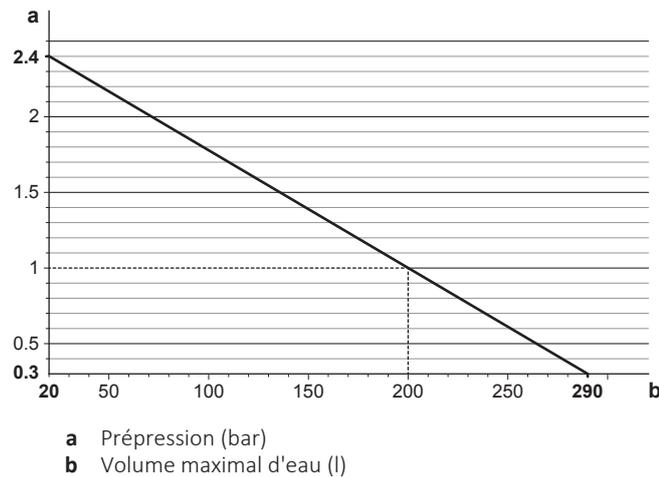
**Exemple: volume maximal d'eau et prépression du vase d'expansion**
