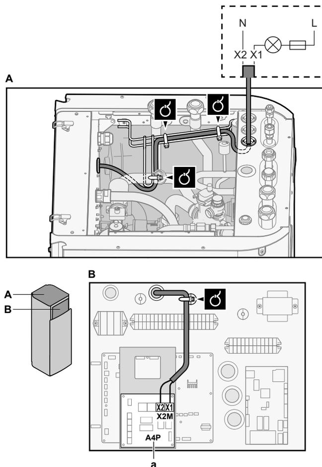
a L'installation de la EKR1HBAA (+ plaque de montage, reportez-vous à "9.4 Installation de la plaque de montage" [▶ 127]) est nécessaire.
