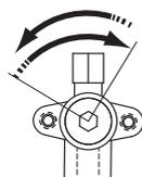
Dans le sens inverse des aiguilles d'une montre pour ouvrir, dans le sens des aiguilles d'une montre pour fermer.
