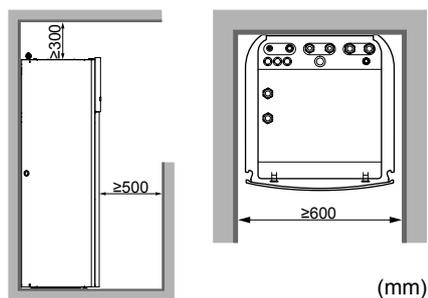
Outre les consignes d'espacement: la pièce dans laquelle vous installez l'unité intérieure doit également respecter les conditions décrites dans la section ["7.1.5 Configurations d'installation"](#) [▶ 56].
