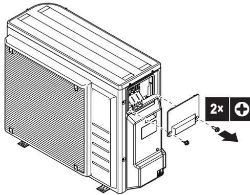
2 Снимите крышку трубопровода хладагента.
