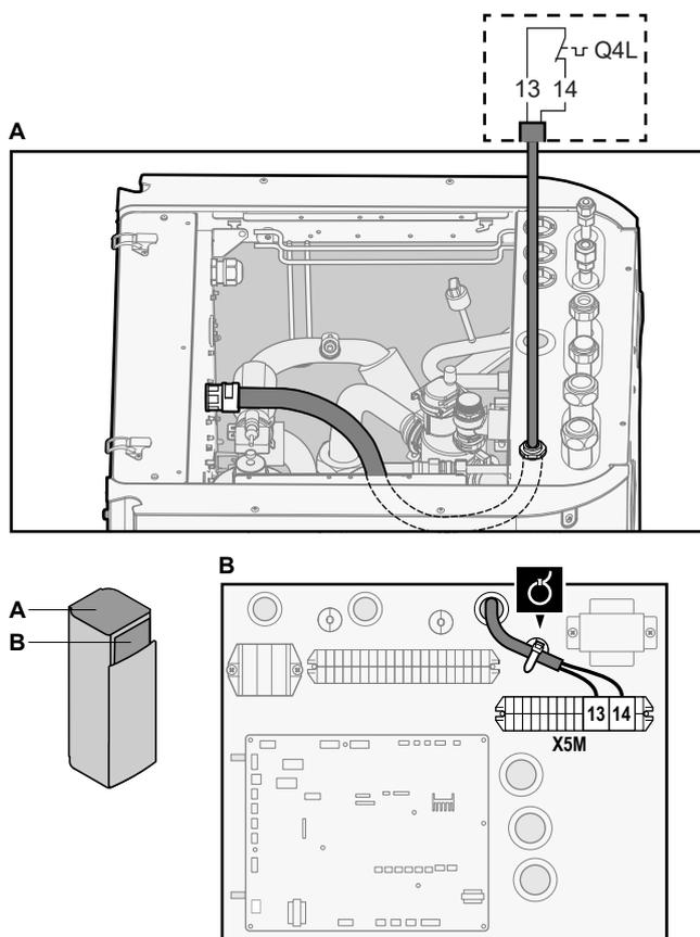
3 Зафиксируйте кабель с помощью стяжек на креплениях кабельных стяжек.
