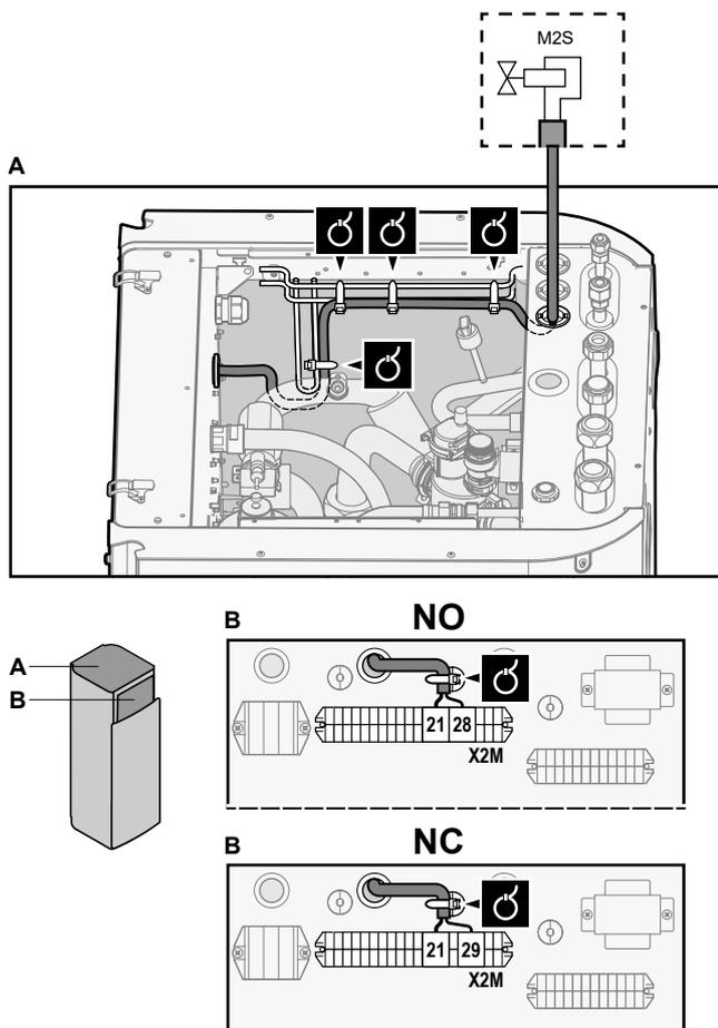
3 Зафиксируйте кабель с помощью стяжек на креплениях кабельных стяжек.
