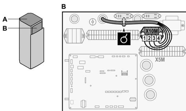
4 Зафиксируйте кабели с помощью стяжек на креплениях кабельных стяжек. При необходимости закрепите слишком длинный кабель кабельной стяжкой.
