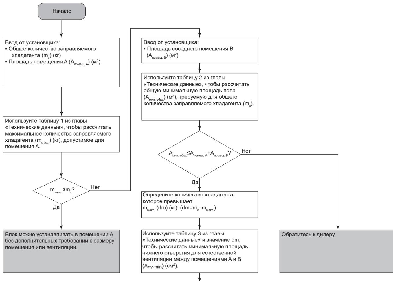
Агрегат можно установить в **помещении А**, если между помещениями А и В имеются 2 отверстия (одно внизу и одно вверху), обеспечивающих естественную вентиляцию. Отверстия должны удовлетворять следующим условиям:
