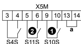
**a** Переключатель (устанавливаются на заводе-изготовителе). Если также подключается предохранительный термостат (Q4L), замените переключатель проводами предохранительного термостата.
