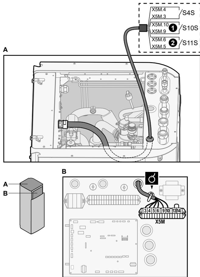
3 Зафиксируйте кабели с помощью стяжек на креплениях кабельных стяжек.
