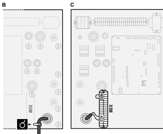
3 Conecte el cableado de alta tensión de la forma siguiente:
