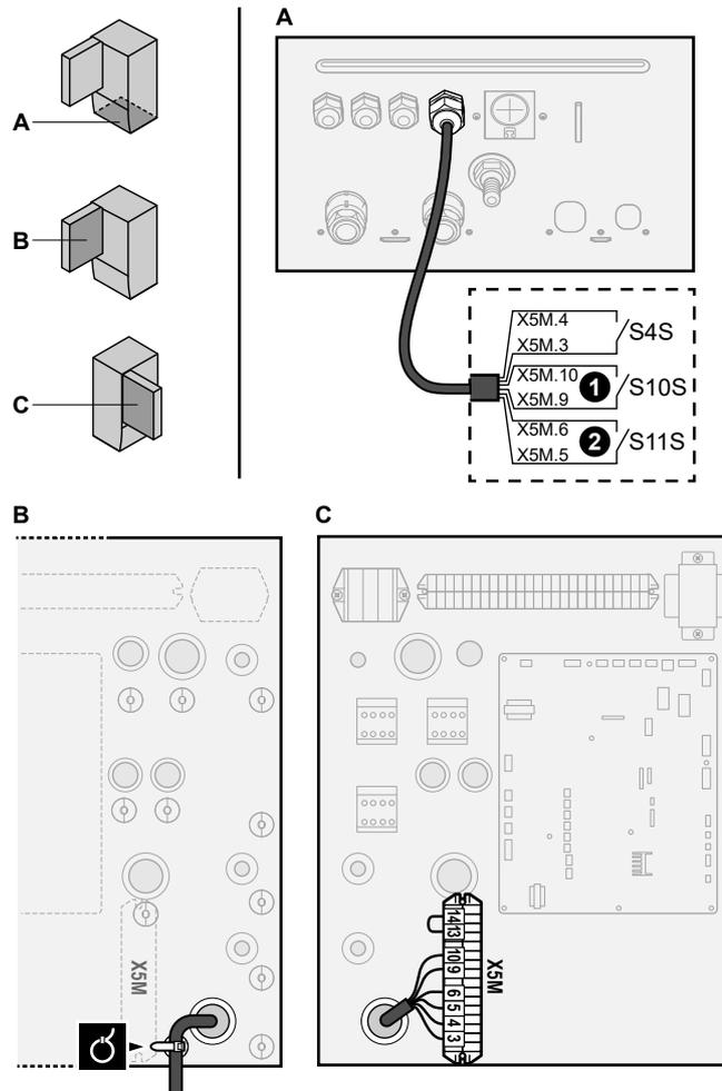
2 Fije los cables con abrazaderas a los sujetacables.
