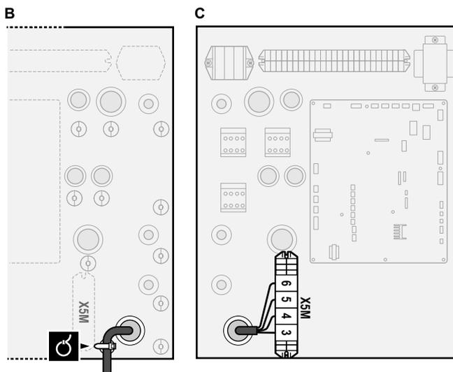
3 Fije el cable con abrazaderas a los sujetacables.
