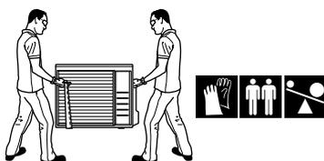
**3** Después de montar la unidad, desconecte la eslinga de la unidad tirando de uno de sus lados.
