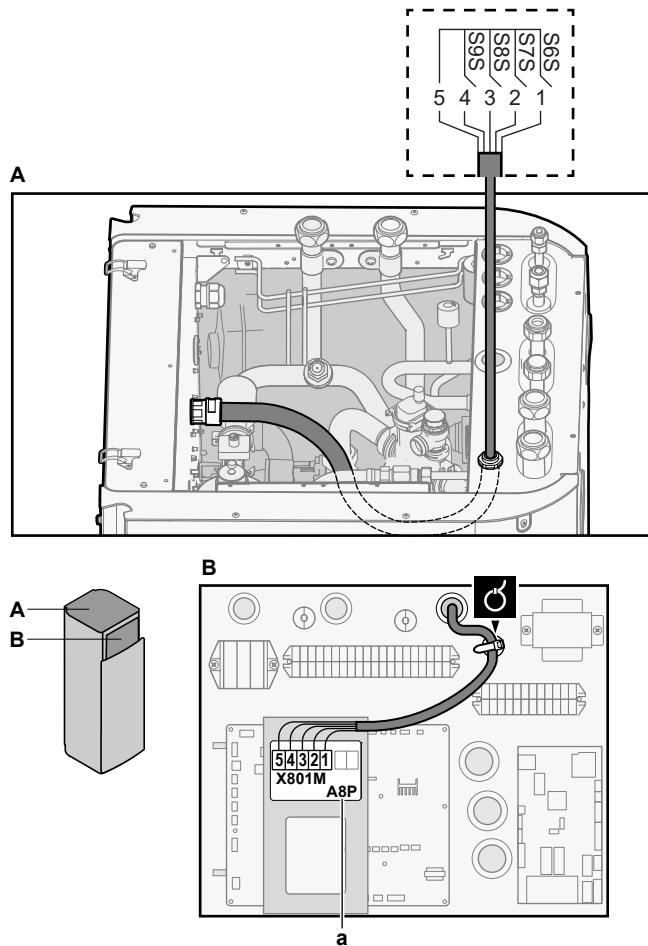
a Montirati je treba EKRP1AHTA (+ montažno ploščo, glejte "9.4 Nameščanje montažne plošče" ▶ 121).
