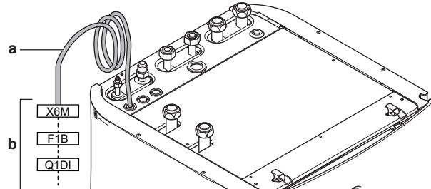
**a** Tovarniško nameščen kabel, priključen na kontaktor rezervnega grelnika v stikalni omarici (K1M)
