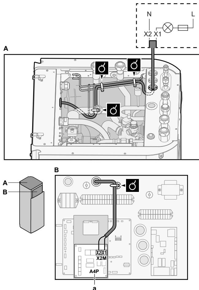
**a** Montirati je treba EKRP1HBAA (+ montažno ploščo, glejte "9.4 Nameščanje montažne plošče" [▶ 121]).
