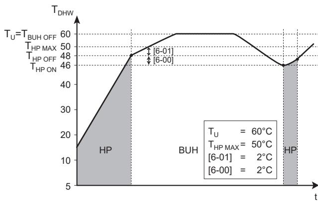
**BUH** Rezervni grelnik**HP** Toplotna črpalka. Če je čas ogrevanja s topotno črpalko predolg, lahko njeno mesto prevzame pomožno ogrevanje z rezervnim grelnikom**T<sub>BUH OFF</sub>****T<sub>HP MAX</sub>**Temperatura za izklop rezervnega grelnika ( $T_u$ )
