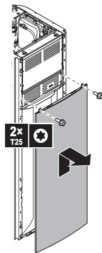
**5** Če potrebujete dostop do visokonapetostnih komponent, odstranite pokrov visokonapetostne stikalne omarice.
