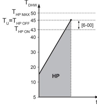
**HP** Toplotna črpalka. Če je čas ogrevanja s topotno črpalko predolg, lahko njeno mesto prevzame pomožno ogrevanje z rezervnim grelnikom**T<sub>HP MAX</sub>** Maksimalna temperatura topotne črpalke na tipalu rezervoarja za sanitarno toplo vodo**T<sub>HP OFF</sub>****T<sub>HP ON</sub>****T<sub>DHW</sub>****T<sub>u</sub>****t****T<sub>u</sub>****t**
