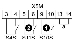
**a** Premostitveni kabel (tovarniško nameščen). Če priključite tudi varnostni termostat (Q4L), nadomestite premostitveni kabel s kabli za varnostni termostat.
