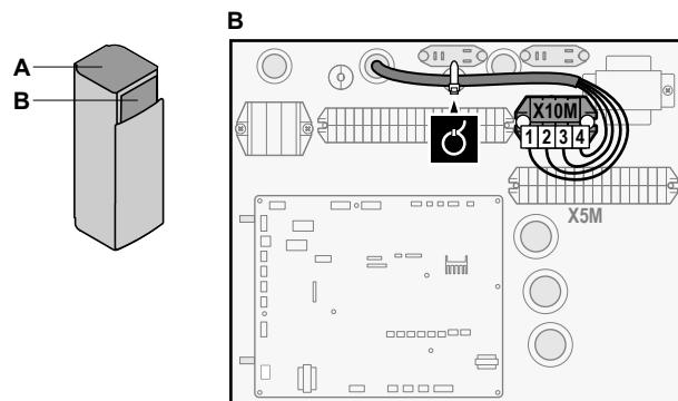
**4** Зафиксируйте кабели с помощью стяжек на креплениях кабельных стяжек. При необходимости закрепите слишком длинный кабель кабельной стяжкой.
