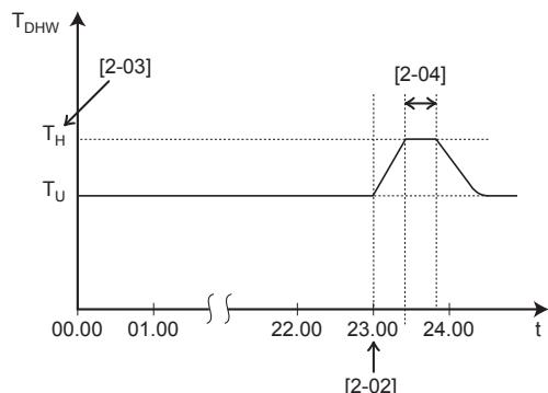
$T_{DHW}$  Температура горячей воды бытового потребления
