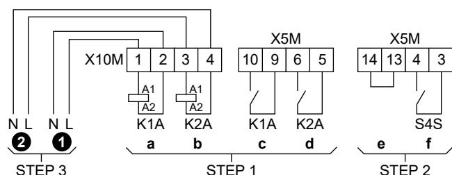
**STEP 1** Монтаж комплекта реле Smart Grid
