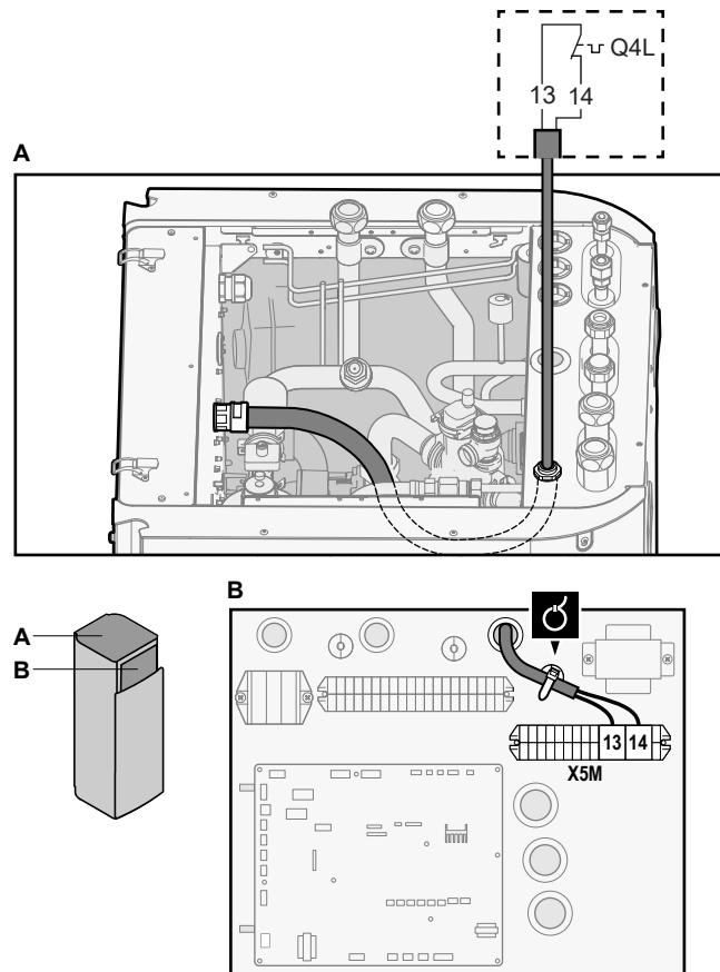
5 Закрепите кабель с помощью стяжек на креплениях кабельных стяжек.
