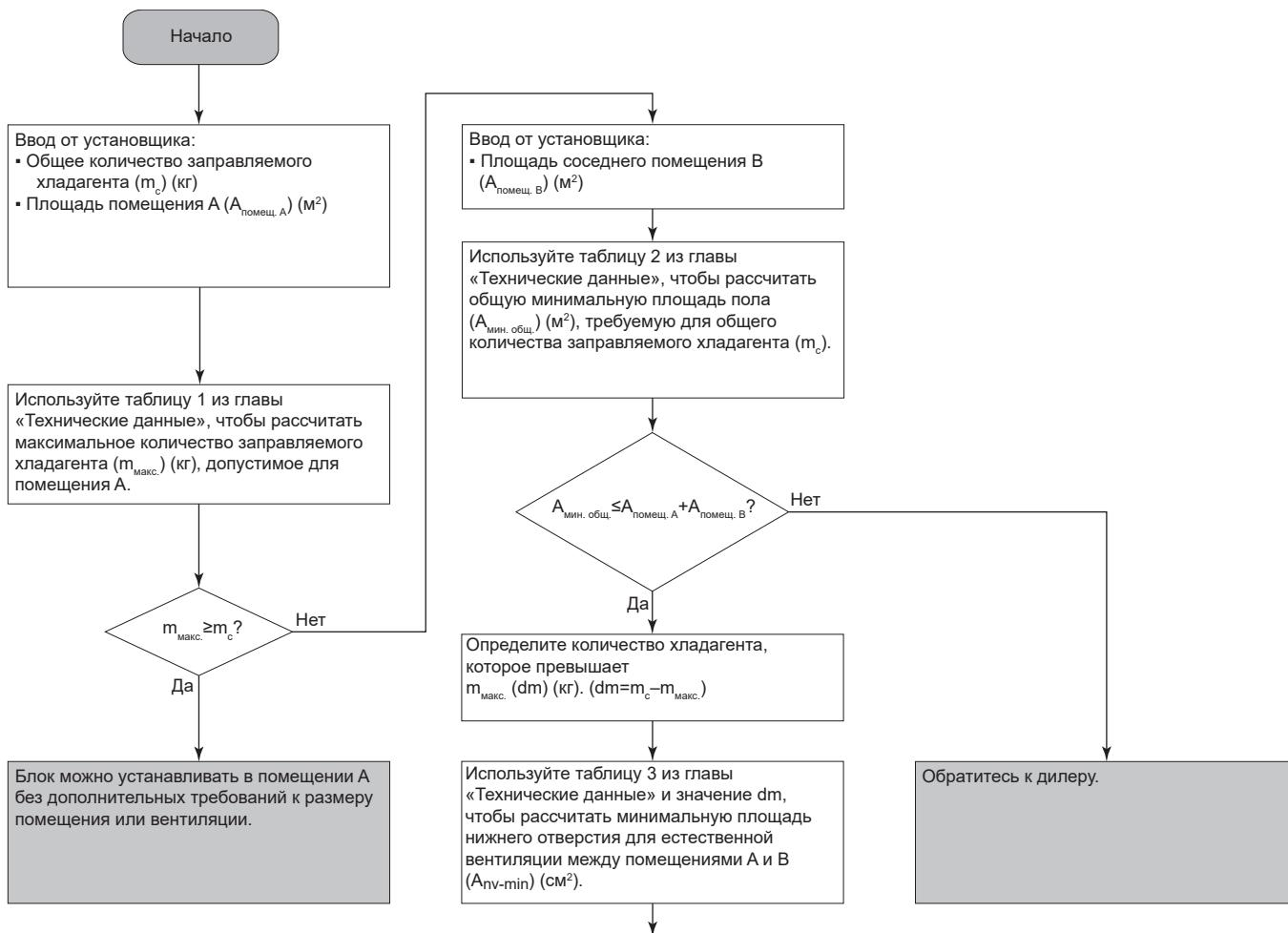
Агрегат можно установить в **помещении А**, если между помещениями А и В имеются 2 отверстия (одно внизу и одно вверху), обеспечивающие естественную вентиляцию. Отверстия должны удовлетворять следующим условиям:
