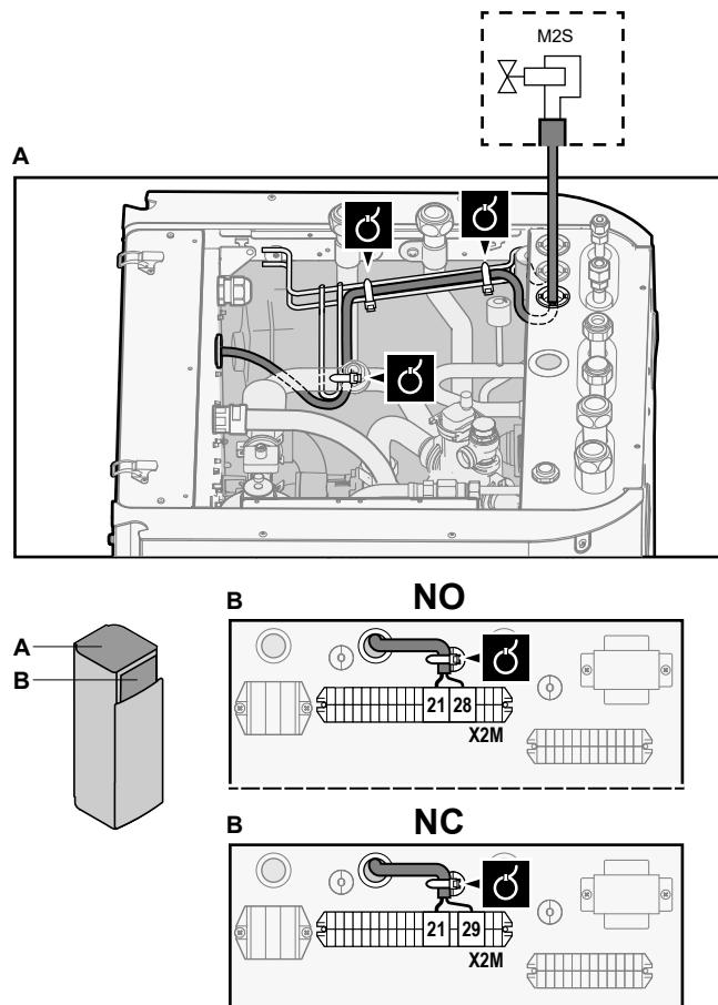
**3** Заденьте кабель с помощью стяжек на креплениях кабельных стяжек.
