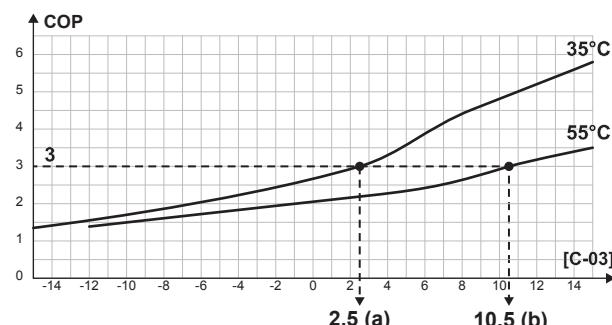
a [C-03]=2,5 при COP=3 и температуре воды на выходе (LWT)=35°C
