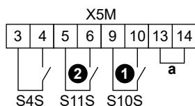
**a** Перемычка (устанавливаются на заводе-изготовителе). Если также подключается предохранительный термостат (Q4L), замените перемычку проводами предохранительного термостата.
