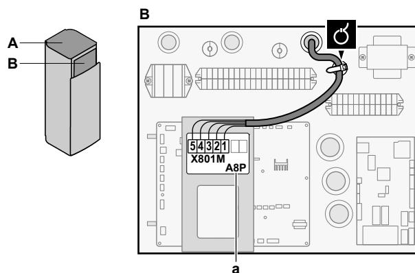
**a** Необходимо установить EKRP1АНТА (+ монтажная пластина, см. раздел [«9.4 Установка монтажной пластины»](#) [▶ 132]).
