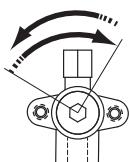
Отвинчивается против часовой стрелки
