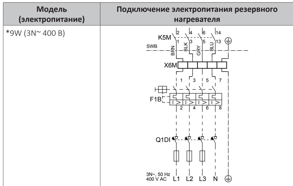
**F1B** Предохранитель защиты от перегрузки (приобретается на месте). Рекомендуется: 4-полюсный; 20 А; кривая 400 В; класс отключающей способности С.
