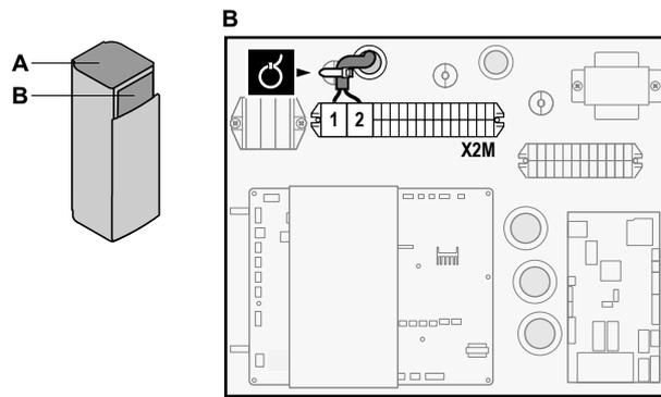
3 Pritvirtinkite kabelį prie kabelių sąvaržų laikiklių.
