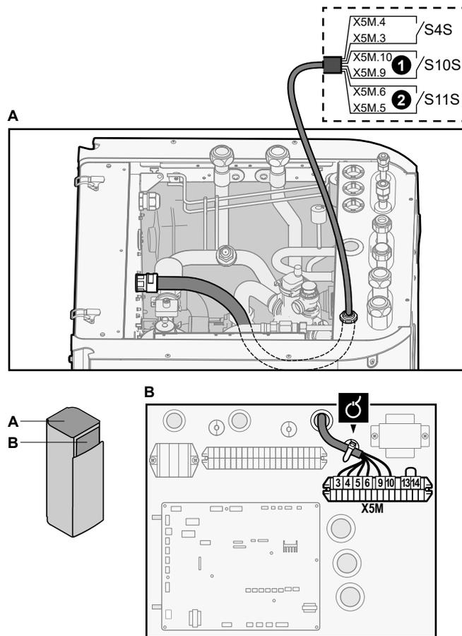
3 Pritvirtinkite kabelius kabelių sąvaržomis prie kabelių sąvaržų laikiklių.
