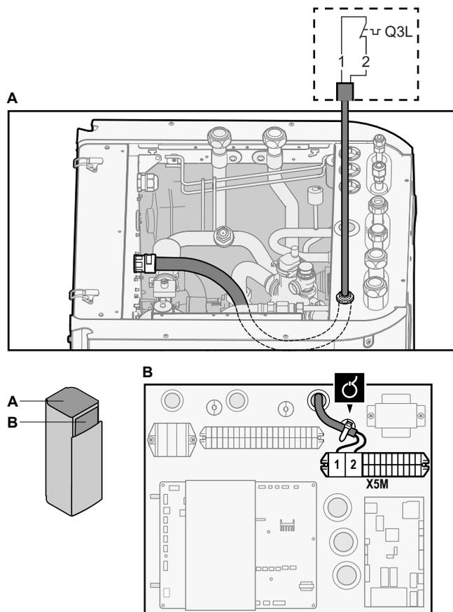
**3** Pritvirtinkite kabelį prie kabelių sąvaržų laikiklių.
