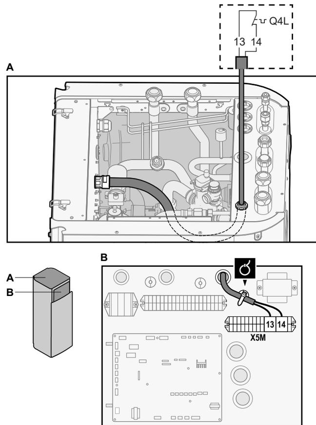
5 Pritvirtinkite kabelį prie kabelių sąvaržų laikiklių.
