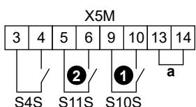
**a** Βραχυκυκλωτήρας (εγκατεστημένος στο εργοστάσιο). Αν συνδέσετε και θερμοστάτη ασφαλείας (Q4L), αντικαταστήστε τον βραχυκυκλωτήρα με τα καλώδια του θερμοστάτη ασφαλείας.
