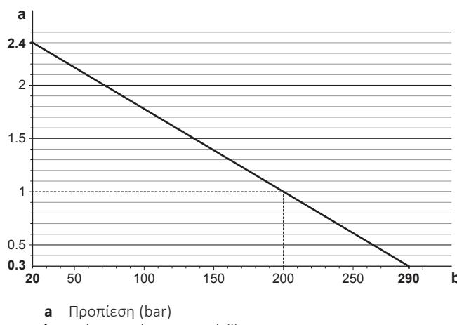
**Παράδειγμα: Μέγιστος όγκος νερού και προπίεση δοχείου διαστολής**
