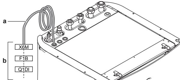
**a** Εργοστασιακά τοποθετημένο καλώδιο συνδεδεμένο στην επαφή του εφεδρικού θερμαντήρα στο εσωτερικό του ηλεκτρικού πίνακα (K1M)
