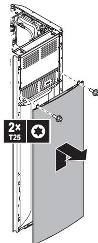
**5** Hvis du har brug for adgang til højspændingskomponenter skal dækslet til højspændings-elboksen fjernes.
