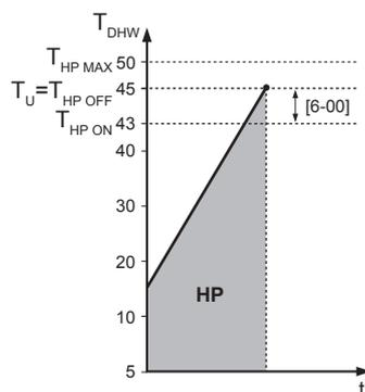
**HP** Varmepumpe. Hvis varmepumpens opvarmningstid er for lang, kan ekstravarmeren starte
