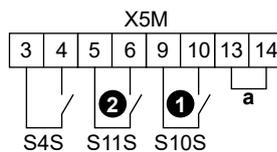
**a** Jumper (fabrikmonteret). Hvis du også tilslutter en sikkerhedstermostat (Q4L), skal du udskifte jumperen med sikkerhedstermostatledningerne.
