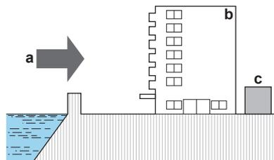
Hvis udendørsenheden er direkte udsat for blæst fra havet, skal der installeres en læskærm.
