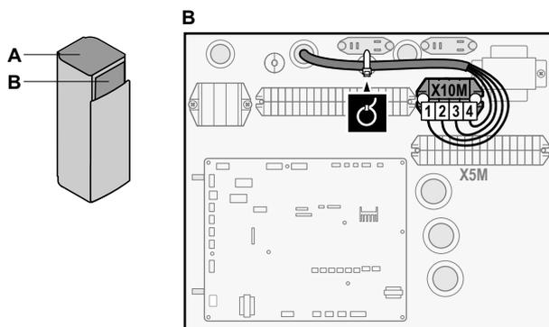
4 Fastgør kablerne med kabelbindere til kabelholdebeslagene. Hvis det er nødvendigt, skal overskydende kabel samles med en kabelbinder.
