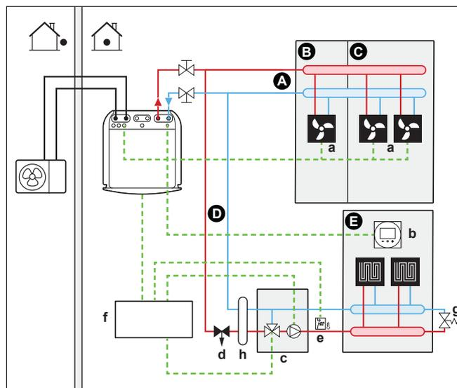
3 System s hydraulickým separátorem pro obě zóny:
