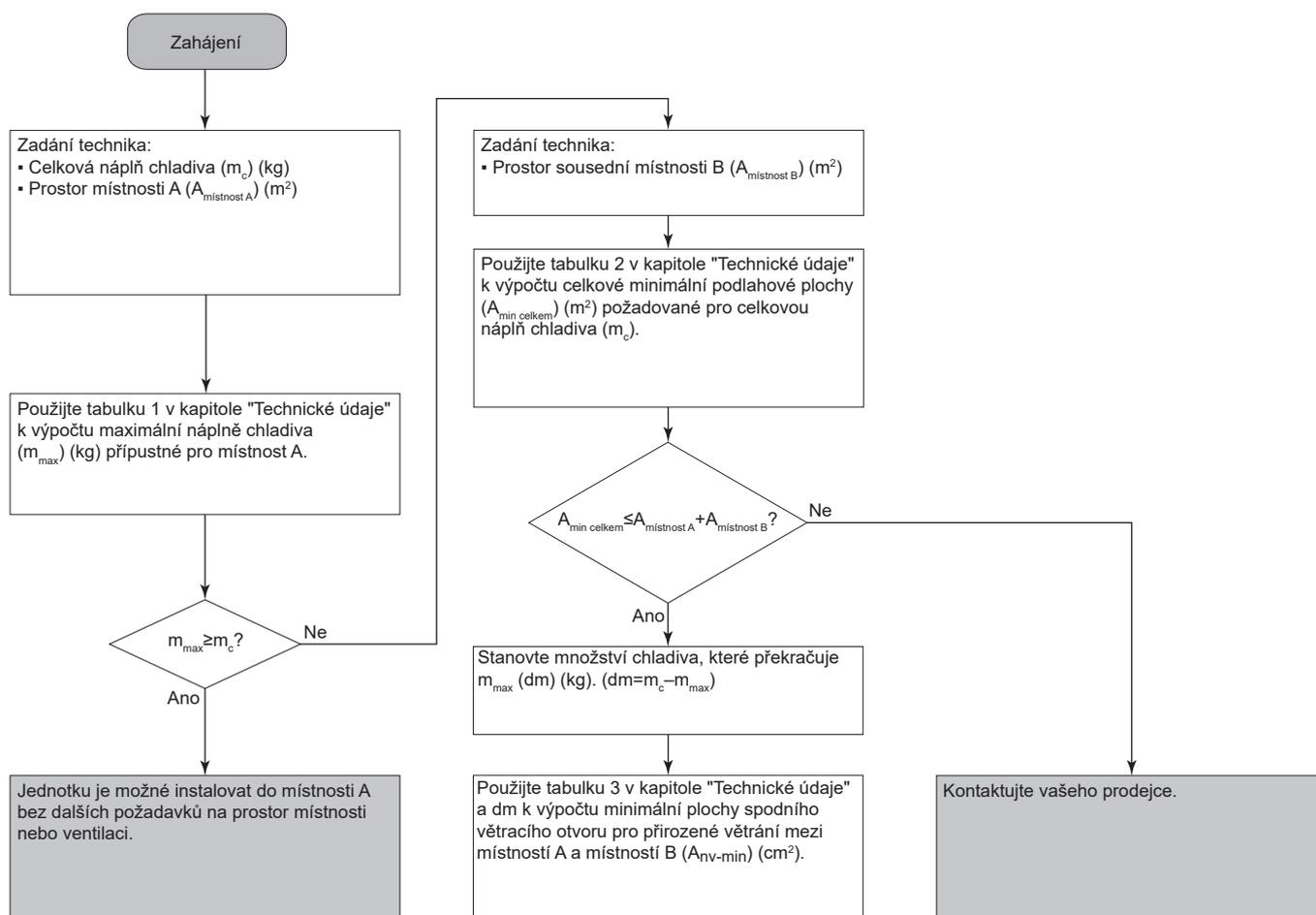
Jednotku lze nainstalovat v **místnosti A**, pokud zajistíte 2 otvory (jeden dole a jeden nahoře) mezi místnostmi A a B pro zajištění přirozeného větrání. Otvory musí splňovat následující podmínky:
