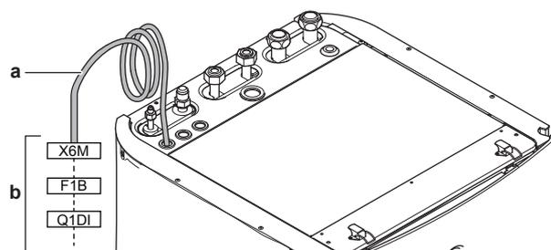
**a** Kabel montovaný ve výrobě připojený ke stykači záložního ohříváče uvnitř prostoru pro elektrické komponenty (K1M)
