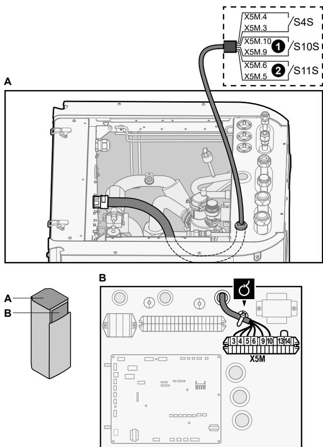
3 Kably upevněte pomocí pásků k upevnění kabelových svazků.
