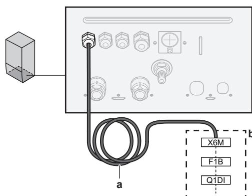
**a** Anahtar kutusu içindeki yedek ısıtıcı kontaktörüne bağlı fabrikada monte edilmiş kablo (K5M)
