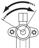
Отвинчивается против часовой стрелки
