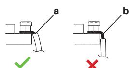
**a** Снимите изоляцию на конце провода до этого места
