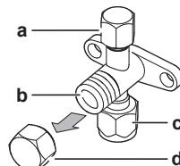
**a** Orificiu pentru service și capacul orificiului pentru service
