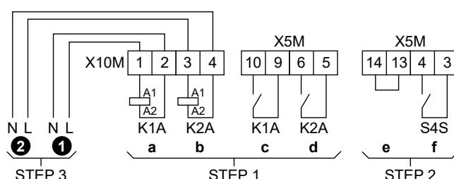
**STEP 1** Instalarea setului de releu pentru aplicația Smart Grid
