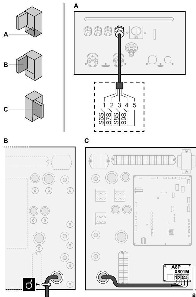
a Trebuie să se instaleze EKRP1AHTA.
