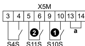
**a** Jumper (montat din fabrică). În cazul în care conectați și un termostat de siguranță (Q4L), înlocuiți jumperul cu firele termostatului de siguranță.
