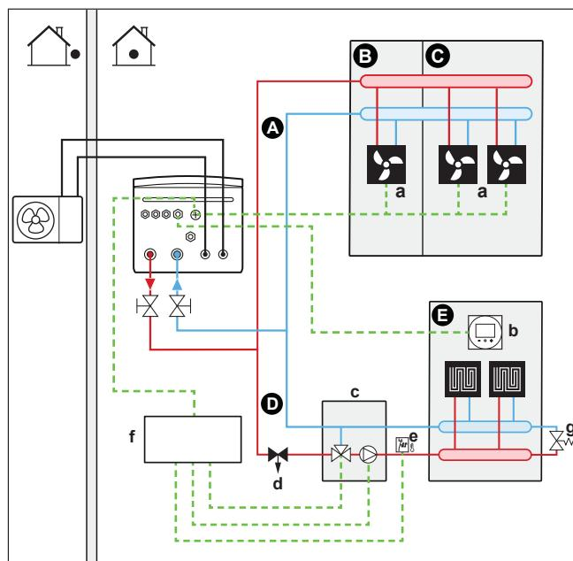
**2 Sistem cu separator hidraulic pentru zona principală:**
