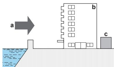
Dacă unitatea exterioară este expusă vântului direct produs de mare, instalați un paravânt.
