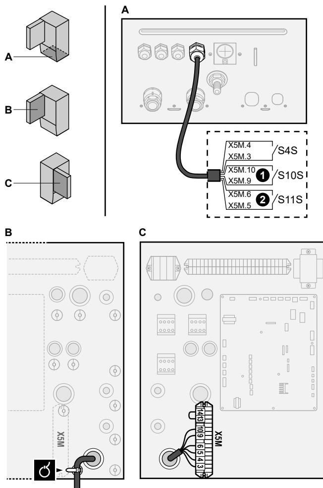
**2** Fixați cablurile cu bride de cablu pe suporturile destinate bridelor de cabluri.
