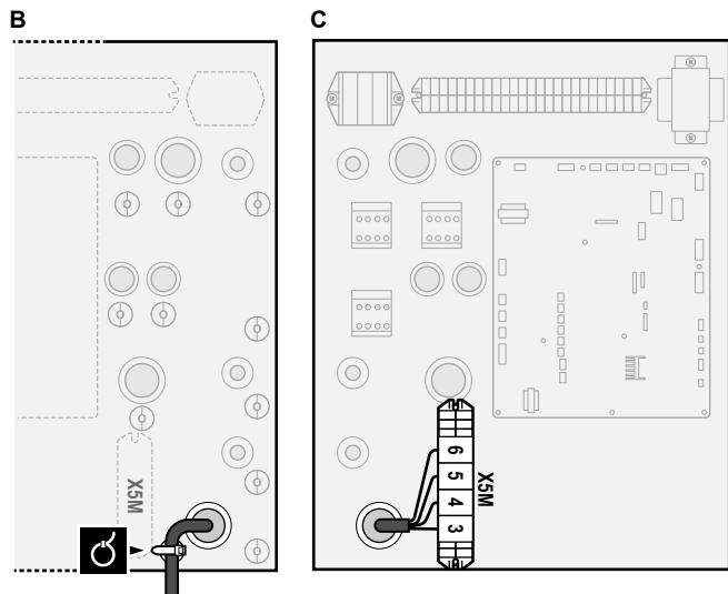
**3** Fixați cablul cu coliere de cablu pe suporturile destinate colierelor de cabluri.
