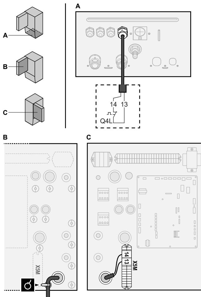
**3** Fixați cablul cu coliere de cablu pe suporturile destinate colierelor de cabluri.
