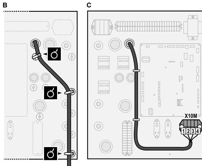
**4** Fixați cablurile cu bride de cablu pe suporturile destinate bridelor de cabluri. Dacă este necesar, legați lungimea excesivă a cablului cu un colier.
