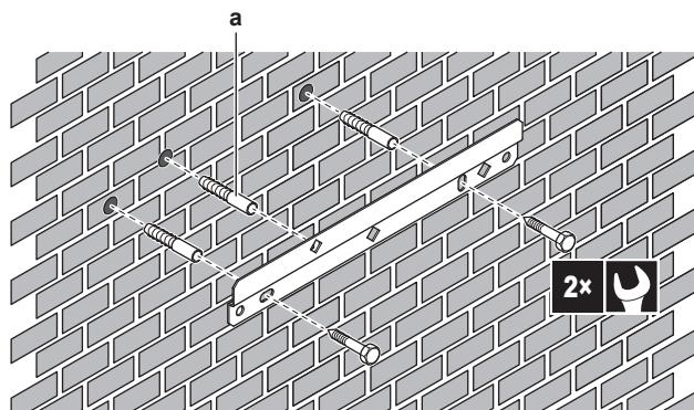
**a** Optional: dacă doriți să fixați unitatea pe perete din interiorul unității, puneți un diblu suplimentar.
