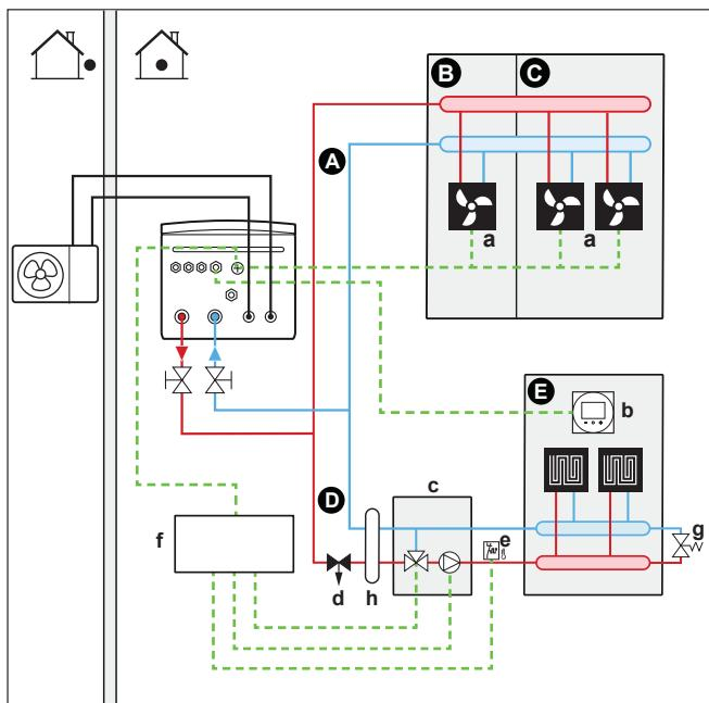
**3 Sistem cu separator hidraulic pentru ambele zone:**
