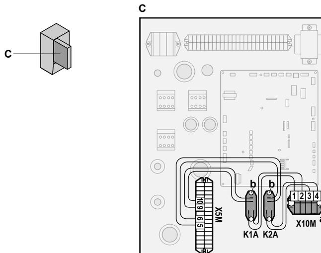
2 Vodiče vedení nízkého napětí připojte následujícím způsobem:
