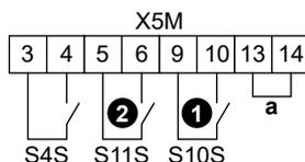
a Propojka (montuje se továrně). Pokud zároveň připojíte bezpečnostní termostat (Q4L), vyměňte propojku za vodiče bezpečnostního termostatu.
