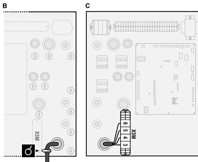
**3** Kabel upevněte pomocí pásků k upevnění kabelových svazků.
