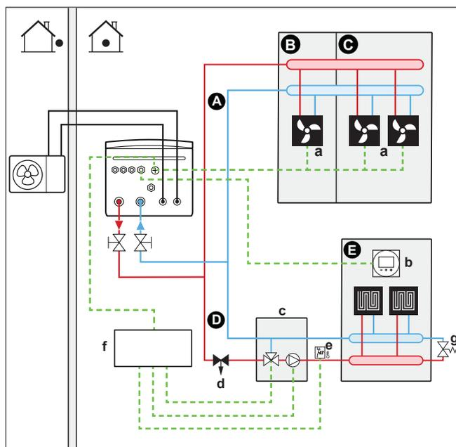
2 Systém s hydraulickým separátorem pro hlavní zónu:
