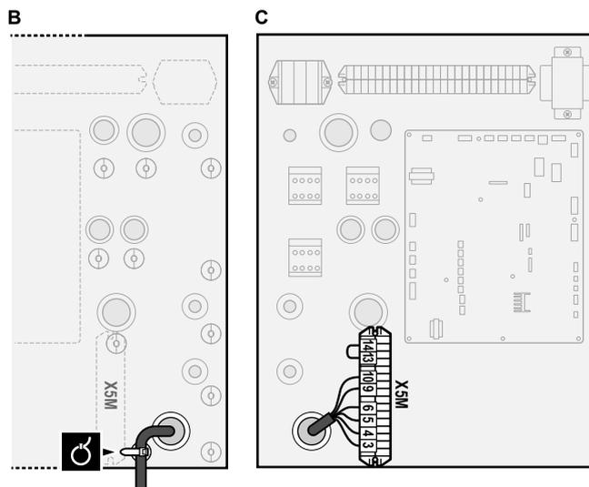
2 Kabely upevněte pomocí pásků k upevnění kabelových svazků.
