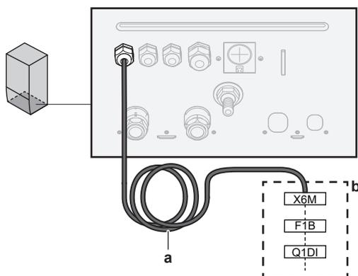
**a** Kabel montovaný ve výrobě připojený ke stykači záložního ohřívače uvnitř prostoru pro elektrické komponenty (K5M)
