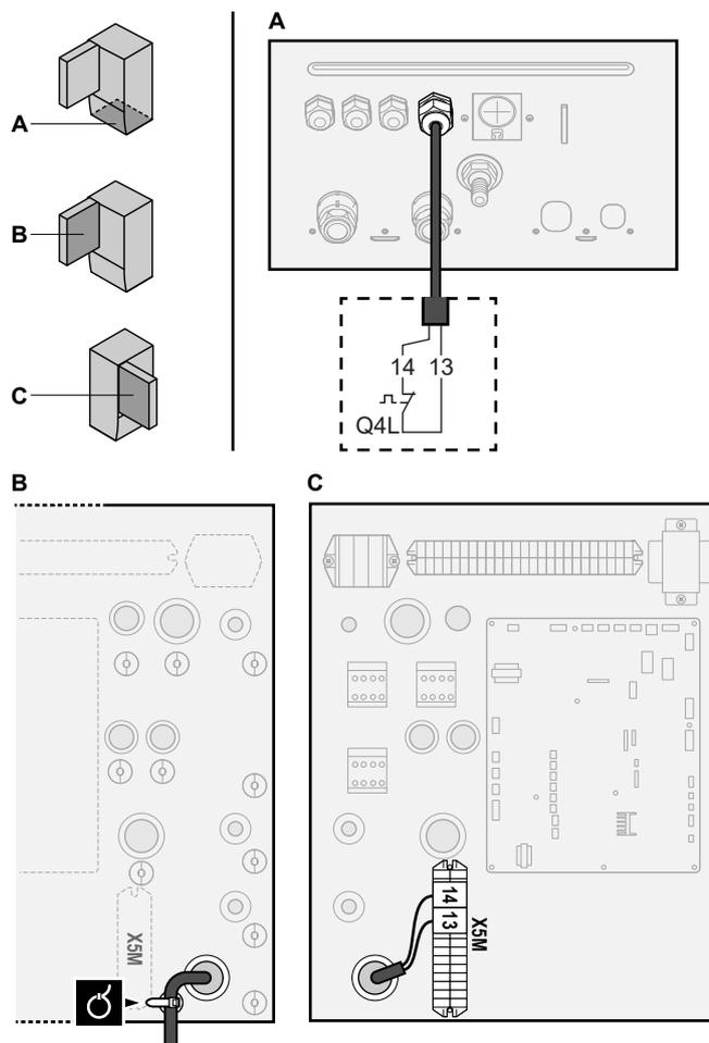
3 Kabel upevněte pomocí pásků k upevnění kabelových svazků.
