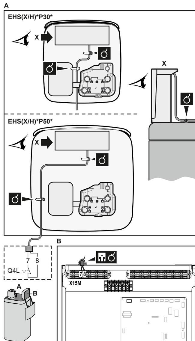
3 Fije el cable con abrazaderas a los sujetacables. Información general, véase "9.3.1 Conexión del cableado eléctrico a la unidad interior" [► 133].
