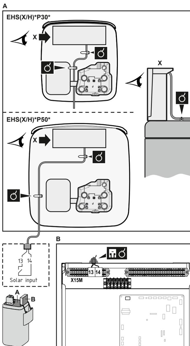
3 Fije el cable con abrazaderas a los sujetacables. Información general, véase "9.3.1 Conexión del cableado eléctrico a la unidad interior" [▶ 133].
