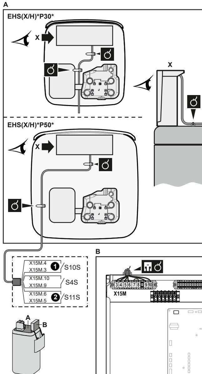
3 Fije los cables con abrazaderas a los sujetacables.
