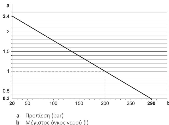
**Παράδειγμα: Μέγιστος όγκος νερού και προπίεση δοχείου διαστολής**
