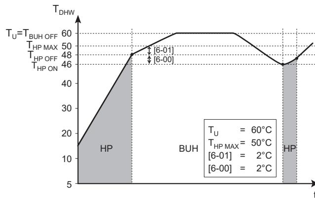
Παράδειγμα: σημείο ρύθμισης ( $T_u$ )≤μέγιστη θερμοκρασία αντλίας θερμότητας-[6-01] ( $T_{HP MAX}$ -[6-01])
