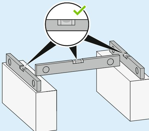
Utilize 4 conjuntos de parafusos de ancoragem M12 com as respectivas porcas e anilhas. Reserve um mínimo de 150 mm de espaço livre por baixo da unidade. Além disso, certifique-se de que a unidade é colocada pelo menos 100 mm acima do nível máximo de neve esperado.
