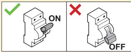
Para avisar o utilizador, fixe os autocolantes "NÃO DESATIVAR o disjuntor" no armário elétrico e o mais próximo possível dos disjuntores da bomba de calor. Preencha o número de referência do disjuntor no autocolante para garantir a máxima clareza.
